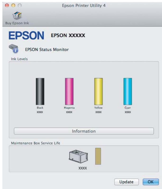
Sie können dieses Utility auch verwenden, um den Tintenpatronenstatus vor dem Drucken zu überprüfen. EPSON Status Monitor zeigt den Tintenpatronenstatus zum Zeitpunkt des Öffnens an. Um den Status der Tintenpatronen zu aktualisieren, klicken Sie auf **Update (Aktualisieren)**.
