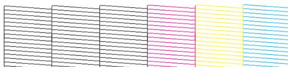
Si aucun segment des lignes imprimées ne manque, comme illustré ci-dessous, cela peut indiquer une buse d'encre obstruée ou une tête d'impression mal alignée.
