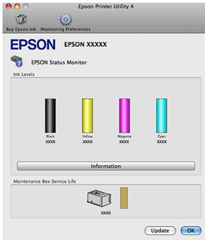
Wenn eine Tintenpatrone fast leer bzw. verbraucht ist oder die Wartungsbox beinahe voll bzw. voll ist, wird die Schaltfläche **How to (Wie Sie)** angezeigt. Klicken Sie auf **How to (Wie Sie)**. Daraufhin gibt Ihnen der EPSON Status Monitor Schritt-für-Schritt-Anweisungen zum Austauschen der Tintenpatrone bzw. der Wartungsbox.
