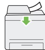
Pode digitalizar papéis soltos utilizando o alimentador automático de documentos (ADF). Ao digitalizar documentos utilizando o ADF, coloque-os virados para cima.
