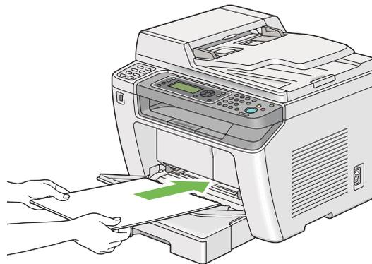
5. Faça deslizar as guias de largura do papel para dentro até entrarem ligeiramente em contacto com as margens da resma de material de impressão.
