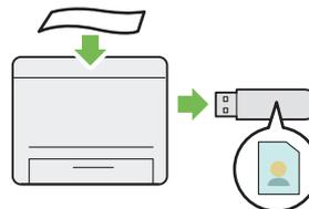
Sie benötigen keinen Computer zum Anschluss Ihres USB-Speichergeräts, um gescannte Daten zu speichern. Setzen Sie Ihr USB-Speichergerät in den Anschluss am Drucker, und speichern Sie die gescannten Daten direkt auf Ihrem USB-Speichergerät.
