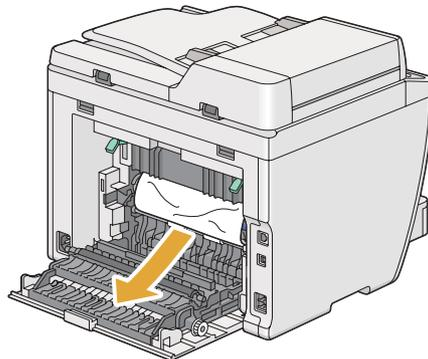
4. Senken Sie die Hebel in die Ausgangsstellung zurück.
