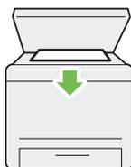
Sie können Seiten eines Buchs oder einer Broschüre von der Dokumentenauflege scannen. Wenn Sie Dokumente mit der Dokumentenauflege scannen, legen Sie sie mit der Vorderseite nach unten weisend auf.
