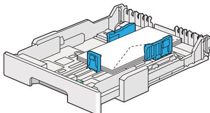
**LEF:** Legen Sie Umschläge mit der bedruckbaren Oberfläche nach oben weisend ein. Stellen Sie sicher, dass die Umschlagklappenkante zur vorderen Druckerseite weist und die Klappen nicht gefaltet sind.
