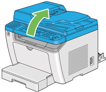
5. Entfernen Sie jegliches gestaute Papier aus dem mittleren Ausgabefach.
