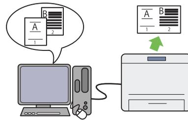
Mit dem Multiple Up (N auf 1)-Druckmerkmal des Druckers können Sie mehrere Seiten auf einem einzelnen Blatt Papier drucken, um den Papierverbrauch zu verringern.
