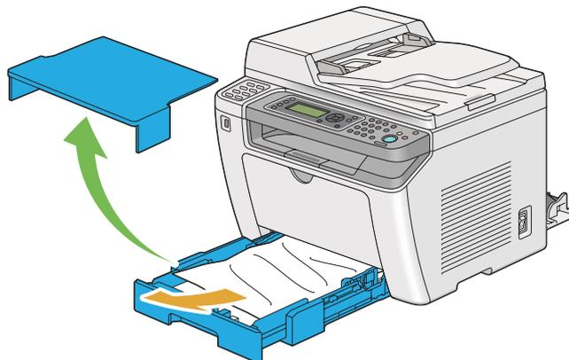
4. Entfernen Sie jegliches gestauchtes und/oder gefaltetes Papier aus dem Behälter.
