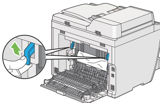
3. Entfernen Sie das gestaute Papier von der Rückseite des Druckers.
