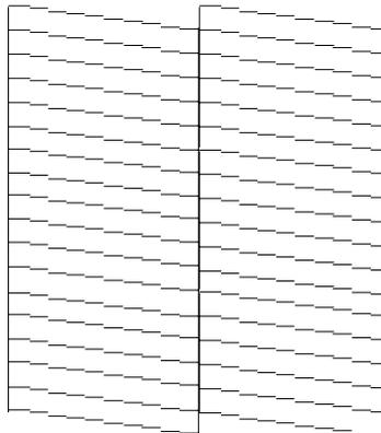
Si aucun segment des lignes imprimées ne manque, comme illustré ci-dessous, cela peut indiquer une buse d'encre obstruée ou une tête d'impression mal alignée.
