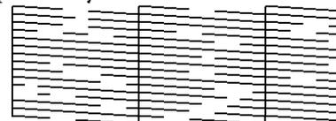
Realice una limpieza de cabezal si falta algún segmento del patrón.
