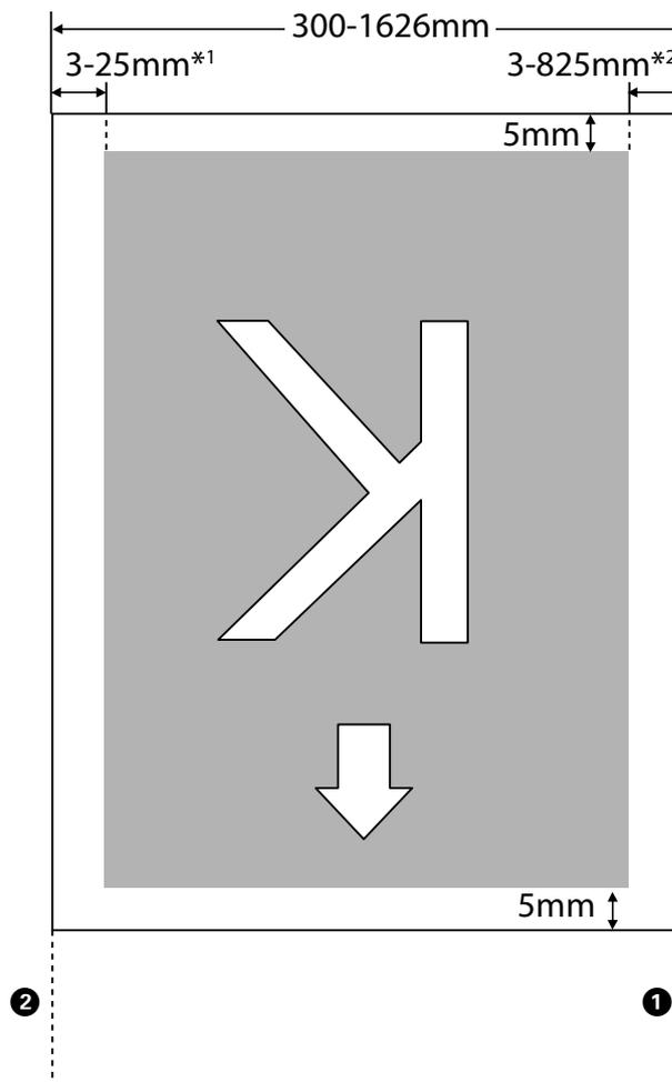
1 Valeur sélectionnée pour le paramètre **Marge latérale(gauche)** dans le menu de configuration. La valeur par défaut est 5 mm.
