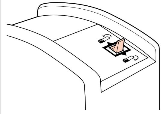
11 Insérez le support au-delà des rouleaux presseurs et abaissez le levier de chargement du support pour le maintenir en place.
