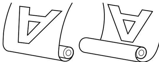
Lors de l'enroulement dans le sens inverse des aiguilles d'une montre, la surface imprimée se trouve sur la partie extérieure du rouleau.
