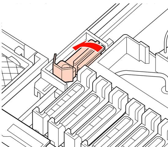
**3** Nettoyez l'avant et l'arrière de l'essuyeur avec une tige de nettoyage.
