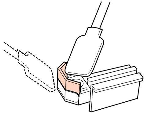
**4** Nettoyez la partie inférieure de l'essuyeur avec une tige de nettoyage.
