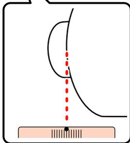
Si la position de chargement n'est pas indiquée sur l'étiquette, marquez-la sur l'étiquette comme indiqué dans le *Guide d'installation* fourni avec l'Enrouleur Auto Gros Rouleaux en option.
