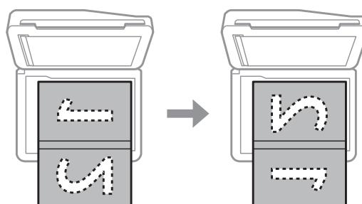
Μπορείτε να εκτυπώσετε δύο σελίδες ενός βιβλίου σε μία όψη ενός φύλλου χαρτιού. Επιλέξτε A4, βιβλ/2εικ. ή Βιβλ/2ψ για τη διάταξη και τοποθετήστε το βιβλίο.
