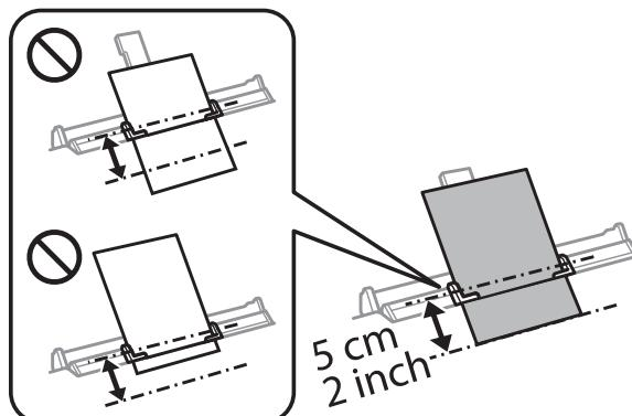
Τοποθετήστε το φάκελο με την κοντή πλευρά πρώτα, το άνοιγμα στραμμένο προς τα κάτω και στο κέντρο της πίσω υποδοχής τροφοδοσίας χαρτιού και, στη συνέχεια, ρυθμίστε τον πλαϊνό οδηγό.
