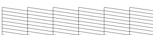
Εάν λείπει κάποιο τμήμα των δοκιμαστικών γραμμών, όπως φαίνεται παρακάτω, αυτό θα μπορούσε να σημαίνει ότι το ακροφύσιο μελανιού είναι φραγμένο ή η κεφαλή εκτύπωσης δεν είναι ευθυγραμμισμένη.
