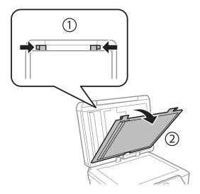
□ Используйте мягкую сухую чистую ткань для очистки внутренней поверхности подложки для документов (только для устройств с функцией автоподатчика).
