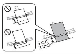
Загрузите конверт узкой стороной вперед с клапаном, обращенным вниз, и по центру заднего слота подачи бумаги, а потом установите боковую направляющую.
