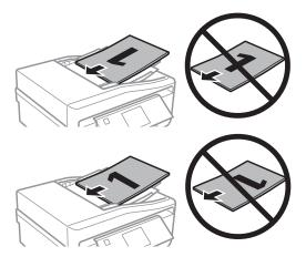
□ Если автоподатчик используется, чтобы выполнить копирование, выполните следующие настройки печати: Меньше/больше - Фактич. размер, Тип бумаги - Обычная бумага и Размер бумаги - А4. Отпечаток обрезается при копировании оригиналов размера, большего чем А4.
