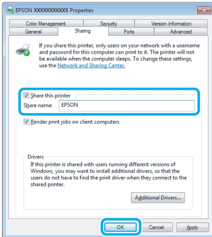
Αν επιθυμείτε την αυτόματη λήψη των προγραμμάτων οδήγησης του εκτυπωτή για υπολογιστές που εκτελούν διαφορετικές εκδόσεις των Windows, επιλέξτε **Additional Drivers (Επιπρόσθετα προγράμματα οδήγησης)**, καθώς και το περιβάλλον και τα λειτουργικά συστήματα των άλλων υπολογιστών. Πατήστε **OK** και εισαγάγετε το δίσκο λογισμικού της συσκευής.
