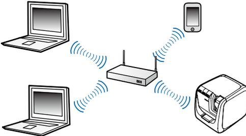
Es stehen zwei Verbindungsmethoden zur Verfügung: eine automatische Konfigurationsmethode unter Verwendung von Wi-Fi Protected Setup (WPS) und eine manuelle Konfigurationsmethode.
