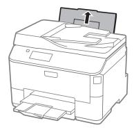
Öffnen Sie die Papierfachschutzblende, drücken Sie die Papierführungsschienen zusammen und verschieben Sie sie.
