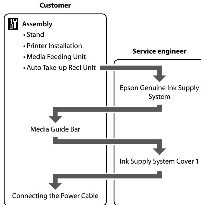
Contactez un technicien pour fixer les éléments « Epson Genuine Ink Supply System » et « Ink Supply System Cover 1 ». Essayer de réaliser ces tâches vous-même peut provoquer le dysfonctionnement du produit ou des dommages et invalidera la garantie.
