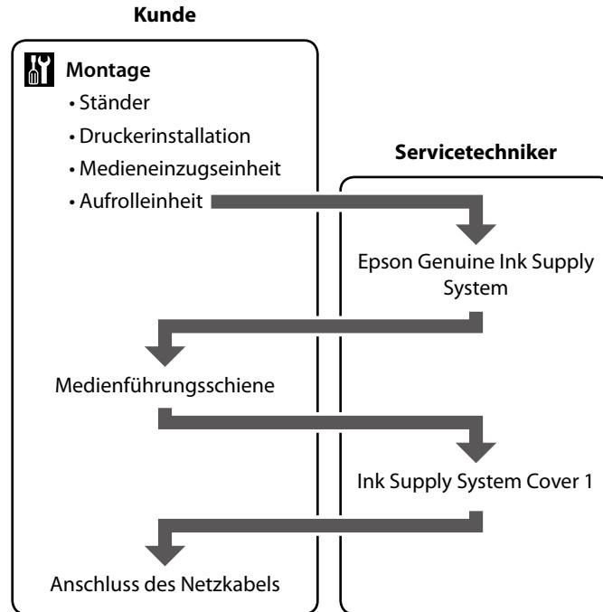
Neem contact op met een servicetechnicus om het “Epson Genuine Ink Supply System” en de “Ink Supply System Cover 1” te bevestigen. Als u deze taken zelf probeert uit te voeren, kan dit leiden tot een slechte werking van of schade aan het product en vervalt de garantie van het product.
