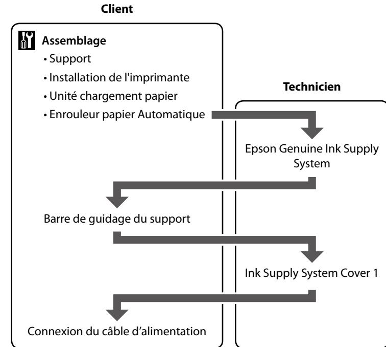
Zur Anbringung des „Epson Genuine Ink Supply System“ und des „Ink Supply System Cover 1“ wenden Sie sich an einen Servicetechniker. Sollten Sie versuchen, diese Arbeiten selbst durchzuführen, kann dies zu Fehlfunktionen des Geräts oder Defekten am Produkt führen und der Garantieanspruch verfällt.
