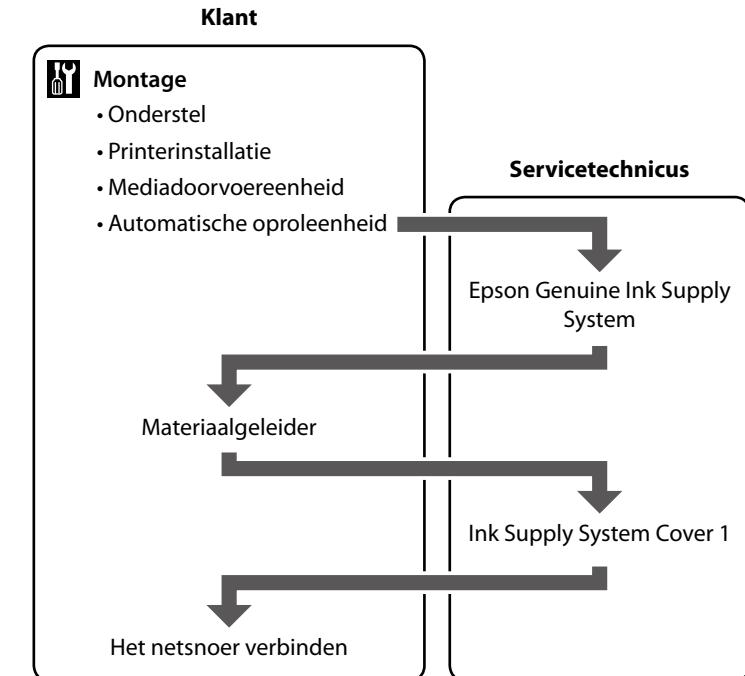
Rivolgersi ad un tecnico dell'assistenza per fissare "Epson Genuine Ink Supply System" e "Ink Supply System Cover 1". Se si tenta di eseguire queste operazioni da soli, si potrebbero causare anomalie o danni al prodotto, con conseguente annullamento della garanzia.
