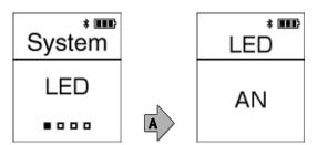
Drücken Sie die Taste [B], und wählen Sie aus [TAP], [FLASH], [ON], [OFF]. Drücken Sie anschließend die [A]-Taste.
