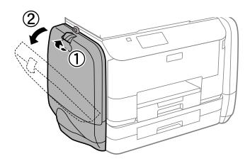
8. Betätigen Sie den Hebel am Tinten-Versorgungs-Einheit. Die Tinten-Versorgungs-Einheit springt heraus.
