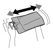
6. Setzen Sie die Tinten-Versorgungs-Einheit so in die Tintengehäuse ein, dass Sie in den Drucker passt.
