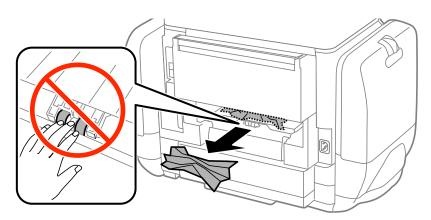
3. Entfernen von gestautem Papier über die hintere Abdeckung
