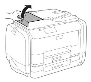
2. Reinigen Sie die Rolle und die Innenseite des ADF mit einem weichen, trockenen und sauberen Tuch.
