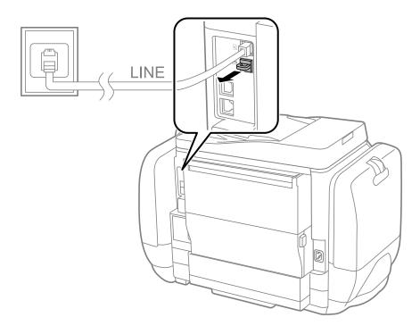
2. Verbinden Sie den Telefonapparat über ein Telefonkabel mit dem EXT.-Anschluss.
