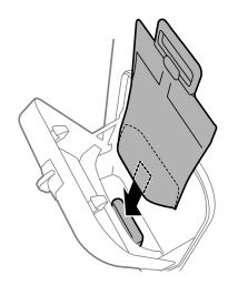
7. Drücken Sie den Hebel der Tinten-Versorgungs-Einheit bis zum Einrasten.
