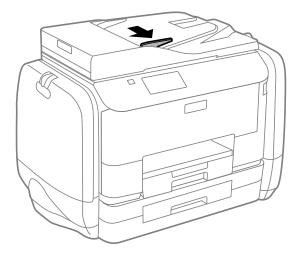
3. Legen Sie die Vorlagen so in den ADF ein, dass die bedruckte Seiten nach oben zeigen.
