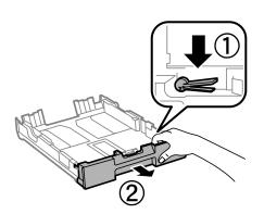
3. Schieben Sie die vordere Papierführungsschiene an die Position, die dem zu verwendenden Papierformat entspricht.
