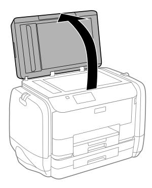
2. Reinigen Sie die Oberfläche des Vorlagenglases mit einem weichen, trockenen, sauberen Tuch.
