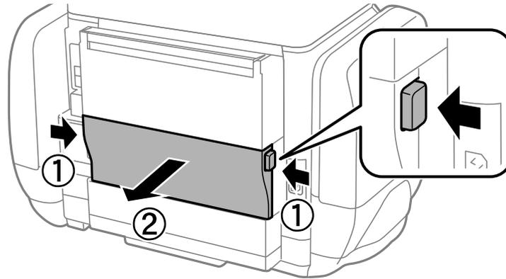
3. Remova a caixa de manutenção usada.
