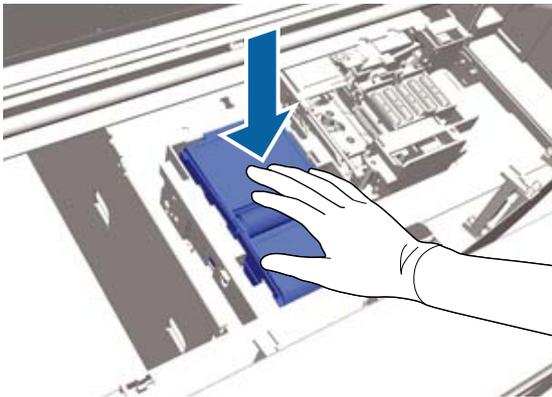
Tauschen Sie nach dem Einbau der neuen Wischereinheit die Austrocknungsschutzkappe aus.
