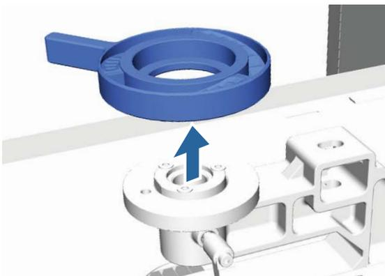
**9** Entfernen Sie den unterhalb des Höheneinstellhebels befindlichen beschrifteten Ring.
