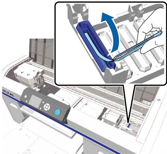
6 Wischen Sie die Innenseite des Saugaufsatzes durch Drehen des dünnen Reinigungsstäbchens.
