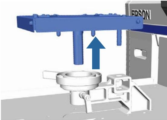
**7** Entfernen Sie die drei Schrauben im Inneren des Höheneinstellhebels.
