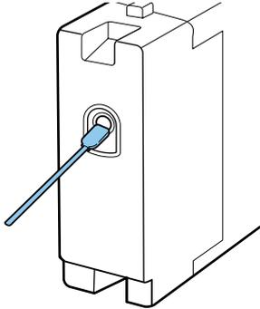
Vergewissern Sie sich beim Verstauen der Patronen, dass der Auslass frei von Staub ist. Der Auslass muss nicht abgedeckt werden, da er über ein innenliegendes Ventil verfügt.
