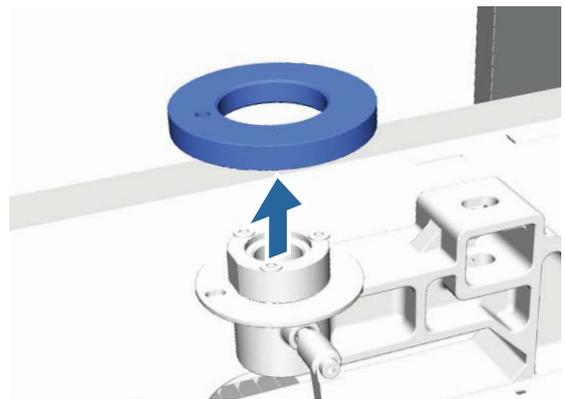
**10** Bringen Sie den Höheneinstellhebel wieder an. Verzichten Sie dabei auf die in Schritt 7 entfernte Schraube!
