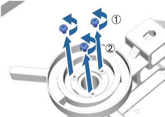
**8** Entfernen Sie den Höheneinstellhebel.
