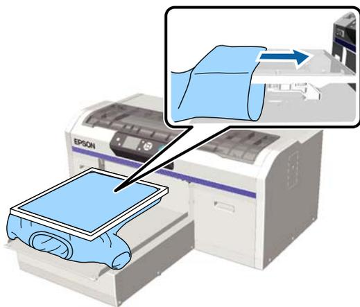
Sollte der Sensor auch dann noch ausgelöst werden, wenn das T-Shirt wie oben abgebildet eingelegt ist, können Sie das Problem möglicherweise lösen, indem Sie den Rahmen entfernen und Knitterfalten sowie Aufwölbungen glattstreichen.
