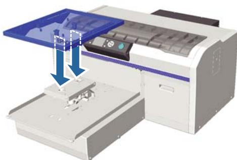
Después de sustituir la platina por otra de un tamaño distinto, le recomendamos que corrija la desalineación de impresión (alineación del cabezal).
