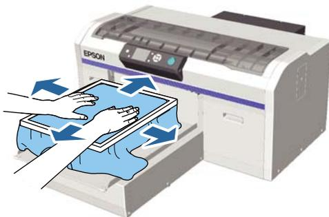
**7** Retire la camiseta del bastidor para eliminar las arrugas y la distensión.
