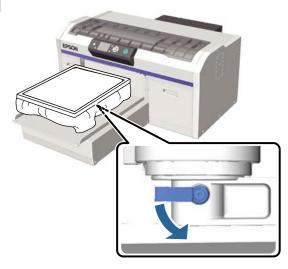
Déplacez le levier de réglage de hauteur pour régler la hauteur du plateau.
