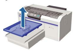
Wérifiez que les axes du plateau de remplacement vont dans les trous.
