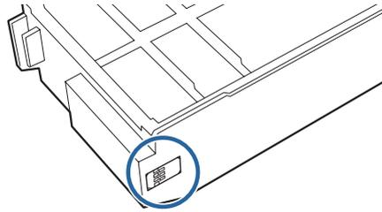
5 Setzen Sie die neue Wartungspatrone ein.
