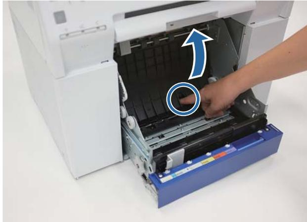
**8** Vergewissern Sie sich, dass sich kein Papier und keine Fremdkörper auf der Rückseite des Druckerinneren befinden.
