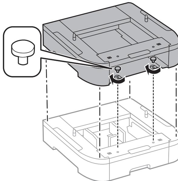
8. Осторожно опустите принтер на дополнительную кассету для бумаги так, чтобы совпали углы, и закрепите по углам винтами.
