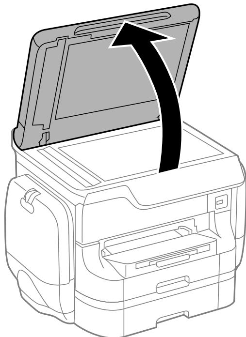
2. Na čistenie sklo skenera používajte mäkkú, suchú a čistú handričku.
