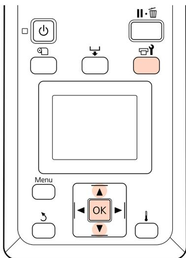
**1** Se pressionar a tecla quando a impressora está pronta para imprimir, o menu Manutenção aparece.
