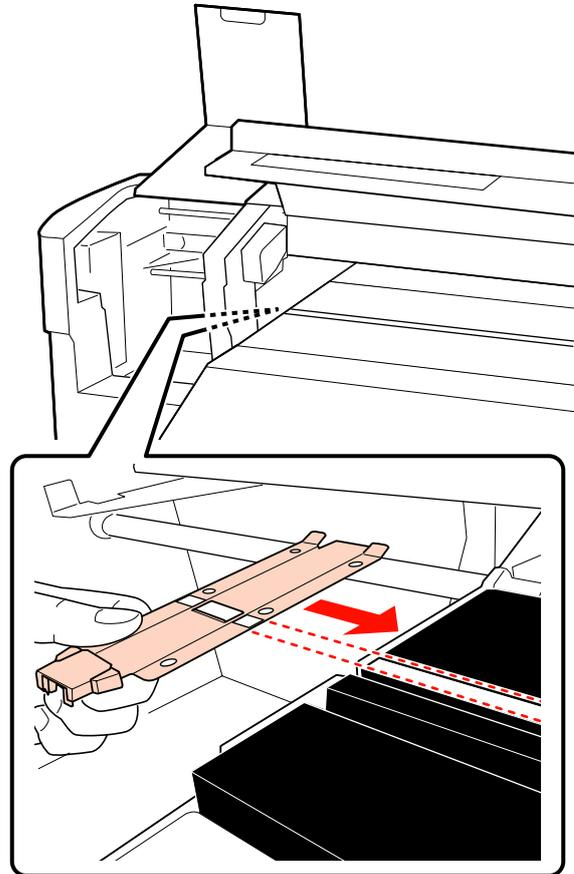
(2) Enquanto pressiona a ponta da presilha metálica contra a superfície dentada, prenda as secções com gancho na parte frontal da superfície dentada.
