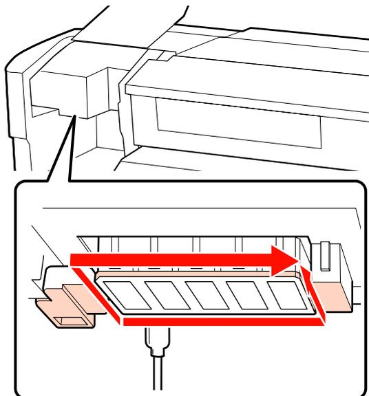
A tinta tem a tendência a aderir às áreas indicadas pelas setas, razão pela qual deverá limpar qualquer tinta existente.
