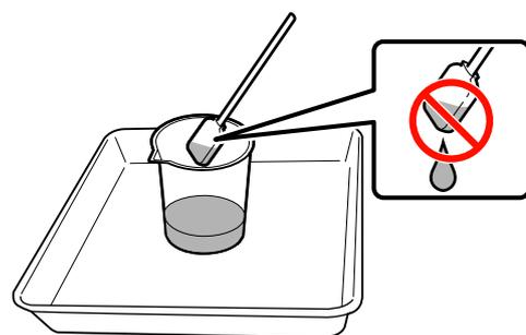
Quando humedecer um pano de limpeza com limpador de tinta, utilize o limpador de tinta vertido para um recipiente.
