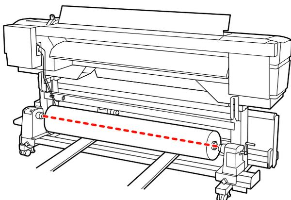
**7** Insira totalmente o apoio do rolo esquerdo. Em seguida, aperte o parafuso do apoio do rolo até ao máximo para fixar o apoio do rolo no devido lugar.
