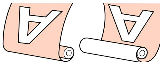
O enrolamento com o lado impresso para fora coloca a superfície impressa no lado exterior do rolo.
