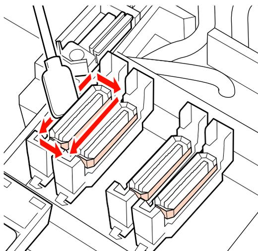
Se a tinta aderir em forma de película à seção de guia na frente e atrás das tampas, e se o pó aderir ao interior da tampa, consulte a próxima seção.
