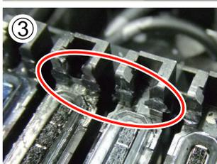
Se o algodão ou pó aderir à área à volta da cabeça de impressão, as tampas (fotografia 1), absorvedor (fotografia 2) ou almofada de descarga, poderão ocorrer obstruções nos jactos durante a impressão. Além disso, se o algodão ou o pó ficar agarrado, as obstruções nos jactos não podem ser eliminadas, mesmo após uma limpeza repetida da cabeça. Como mostrado na fotografia (3), em caso de aderência de películas ou tinta, a protecção não funciona, causando uma falha de impressão.
