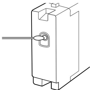
Enquanto os tinteiros estiverem guardados, mantenha as saídas de tinta sem pó. A saída da tinta contém uma válvula, pelo que não necessita de ser protegida.
