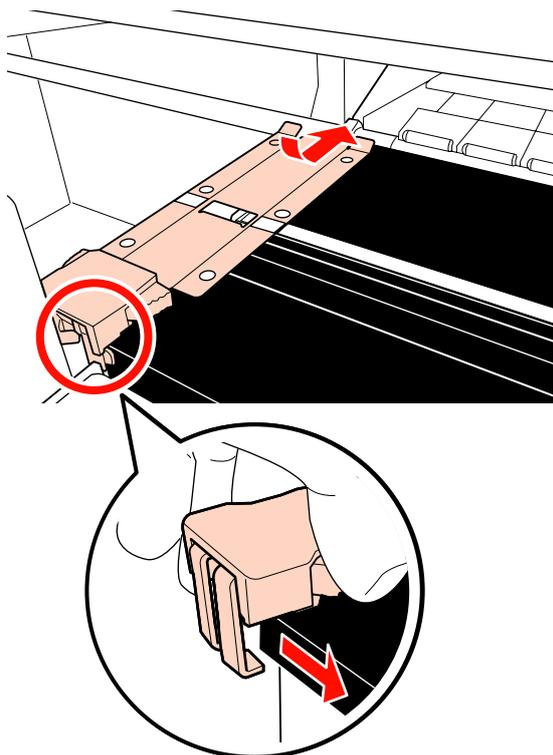
**5** Verifique se as duas secções com gancho na parte posterior da superfície dentada estão fixas como mostrado abaixo e que estão fixas sem folga entre a presilha e a superfície dentada.
