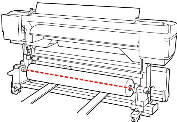
**6** Insira totalmente o apoio do rolo esquerdo. Em seguida, aperte o parafuso do apoio do rolo até ao máximo para fixar o apoio do rolo no devido lugar.
