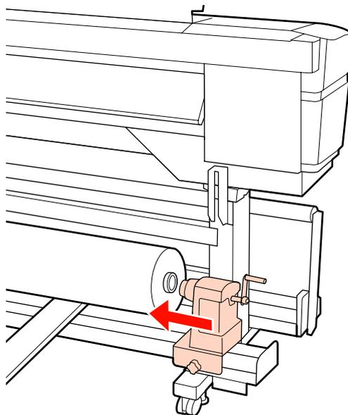
**9** Para garantir que o apoio do rolo esteja suficientemente inserido no núcleo do rolo, empurre a secção central na parte lateral do apoio do rolo no sentido da extremidade do rolo duas vezes.
