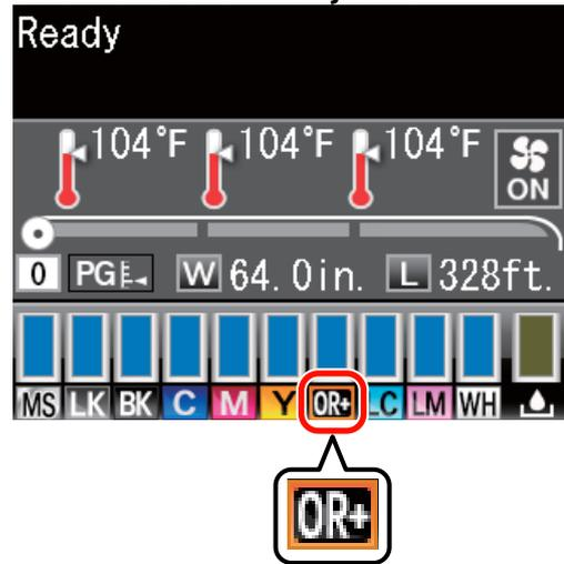
Cuando cambie el tipo de tinta naranja, lleve a cabo el siguiente procedimiento de cambio de tinta. Si el procedimiento no se lleva a cabo y se instala un tipo diferente de cartucho de tinta naranja, se produce un error y la impresora no puede utilizarse.
