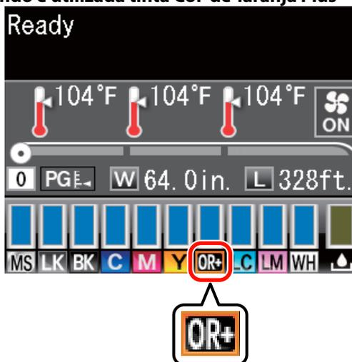
Ao mudar o tipo de tinta cor-de-laranja, realize o procedimento de mudança de tinta abaixo. Se o procedimento não for realizado e for instalado um tipo de tinteiro cor-de-laranja diferente, ocorre um erro e a impressora não pode ser utilizada.
