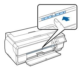
Legen Sie das Papier mit der bedruckbaren Seite nach oben vertikal ein.
