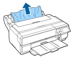
Öffnen Sie die Druckerabdeckung und ziehen Sie das eingeklemmte Papier langsam aus dem Drucker.
