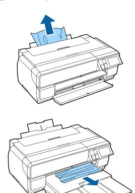
Öffnen Sie die Druckerabdeckung und ziehen Sie das eingeklemmte Papier langsam aus dem Drucker.
