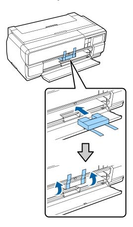
Schließen Sie die vordere Abdeckung und befestigen Sie sie mit handelsüblichem Klebeband.
