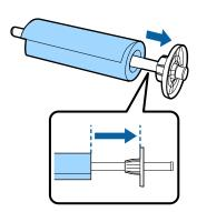
Drücken Sie den schwarzen Flansch, damit sich keine Lücke zwischen Flansch und Rollenpapier befindet.
