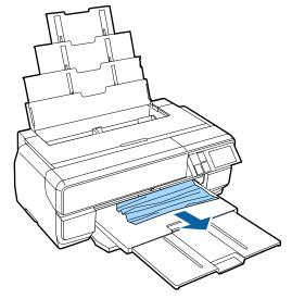
Öffnen Sie die Druckerabdeckung und ziehen Sie das eingeklemmte Papier langsam aus dem Drucker.
