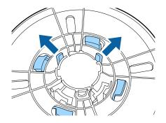
Drücken Sie auf gleiche Weise die Haken heraus und entfernen Sie das Zubehör vom Flansch, der an der Spindel befestigt ist.
