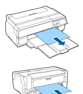
Öffnen Sie die Druckerabdeckung und ziehen Sie das eingeklemmte Papier langsam aus dem Drucker.
