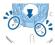
Stecken Sie auf gleiche Weise zunächst das Zubehör in die Spindel; bringen Sie es dann an dem an der Spindel befestigten Flansch an.
