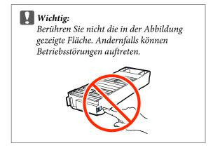
Heben Sie den Wartungstank an und entfernen Sie ihn vorsichtig, sodass er nicht umkippt.
