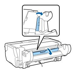
Installieren Sie die Spindel mit dem Rollenpapier in der Einheit.
