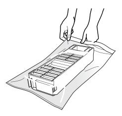
6 Setzen Sie den neuen Wartungstank ein.
