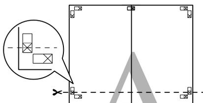
**7** Sovrapporre il foglio superiore sul foglio inferiore. Allineare i crocini X come mostrato nella figura sotto riportata e fissare temporaneamente applicando del nastro adesivo sul retro.
