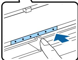
**3** Estendere solo la seconda sezione del vassoio di uscita.
