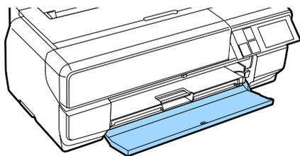
**4** Premere sul centro del vassoio di alimentazione manuale anteriore per farlo uscire.
