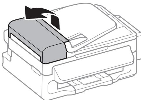
2. Nettoyez le rouleau et l'intérieur du chargeur à l'aide d'un chiffon doux, sec et propre.
