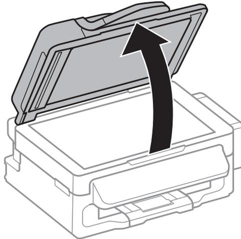
2. Utilisez un chiffon doux, sec et propre pour nettoyer la surface de la vitre du scanner.
