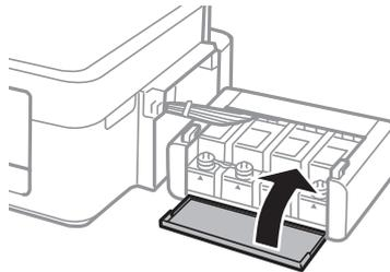
10. Prenda a unidade dos depósitos de tinta à impressora.
