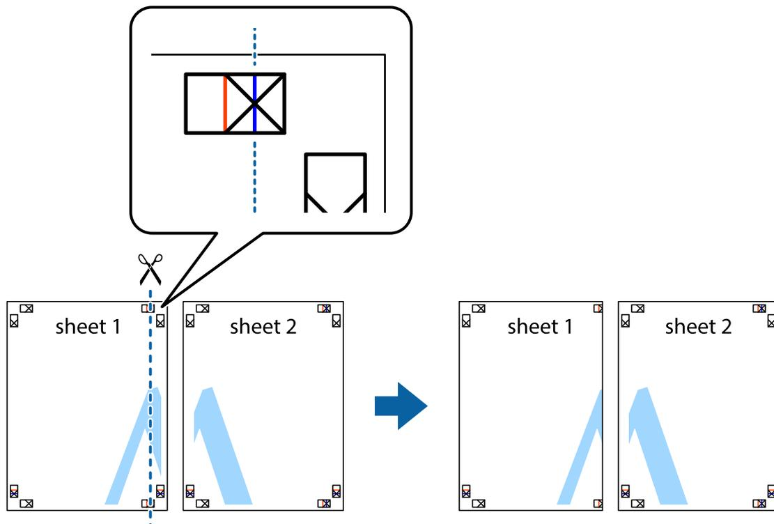
2. Coloque a margem da Sheet 1 em cima da Sheet 2, alinhe as marcas em cruz e cole temporariamente as duas folhas juntas pela parte de trás.
