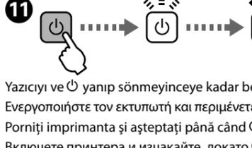
16. Yazıcıyı ve uyanıp sönmeyinceye kadar u simgesine 3 saniye basın. Mürekkep doldurma işlemi başlar. Πατήστε το u για 3 δευτερόλεπτα, μέχρι να αρχίσει να αναβοσβήνει το u. Ξεκινά η φόρτωση του μελανιού. Apăsăți u timp de 3 secunde până când u începe să lumineze intermitent. Schimbarea cernelii începe. Натиснете u за 3 секунди, докато u започне да мига. Зареждането с мастило започва.
