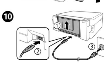
15. Yazıcıyı ve uyanıp sönmeyinceye kadar bekleyin. Ενεργοποιήστε τον εκτυπωτή και περιμένετε μέχρι να πάψει να αναβοσβήνει το u. Porniți imprimanta și așteptați până când u nu mai luminează intermitent. Включете принтера и изчакайте, докато u спре да мига.
