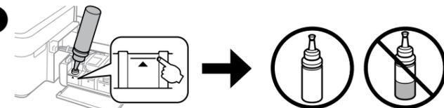
Prirovňajte farbu atramentu k zásobníku a potom ho úplne naplňte atramentom. Potrivíți culoarea cernelii cu rezervorul și apoi alimentați cu toată cerneala. Изберете цвета на мастилото според резервоара, после го напълнете с цялото мастило.
