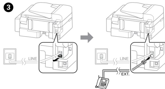
Ak chcete zdieľať rovnakú telefónnu linku ako telefón alebo odkazovač, odstráňte veko a potom pripojte druhý telefónny kábel.
