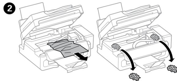
Vyberte všetok papier vo vnútri vrátane všetkých roztrhnutých kúskov. Îndepărtați întreaga hârtie din interior, inclusiv orice bucăți de hârtie rupte.
