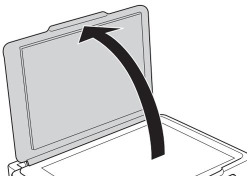
2. Utilisez un chiffon doux, sec et propre pour nettoyer la surface de la vitre du scanner.
