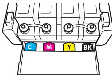
7. Détachez la partie supérieure du capuchon, retirez le capuchon de la bouteille d'encre, retirez le film étanche de la bouteille, puis remettez le capuchon.
