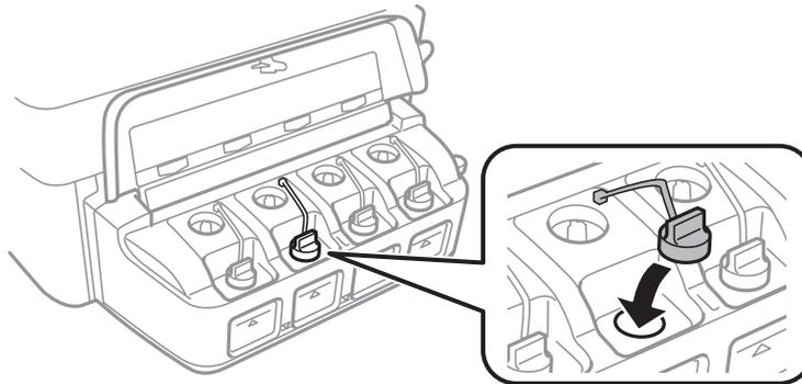
9. Die Abdeckung der Tintenbehältereinheit schließen.
