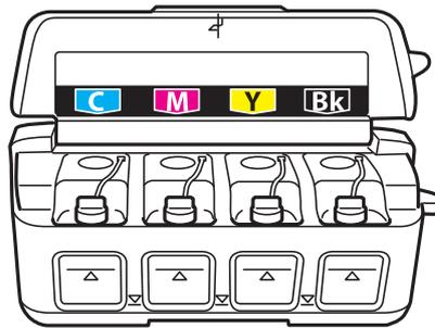
6. Die Deckelkappe entfernen, den Deckel der Tintenflasche und die Dichtung der Tintenflasche entfernen und den Deckel wieder aufsetzen.
