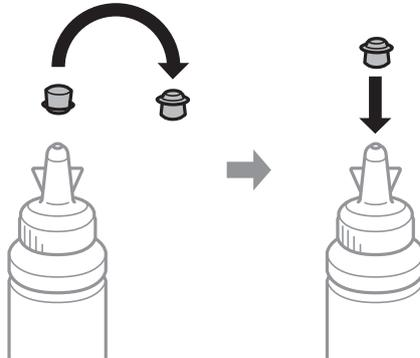
8. Den Tintenbehälter mit dem Deckel sicher verschließen.
