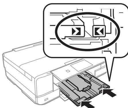
9. Verifique as definições de tamanho e tipo de papel apresentadas no painel de controlo. Para utilizar as definições, prima **Confirmar**. Para alterar as definições, prima **Alterar** e avance para o passo seguinte.
