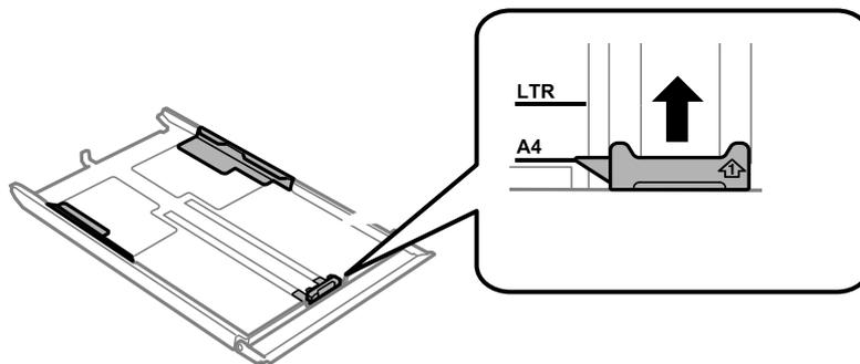
6. Com a face imprimível voltada para baixo, coloque o papel encostado à guia de margem frontal.
