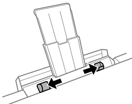
6. Coloque uma única folha de papel no centro da entrada alim. posterior com o lado imprimível voltado para cima e, de seguida, introduza-a cerca de 5 cm na impressora. Ouvirá um sinal sonoro quando o papel estiver colocado correctamente.
