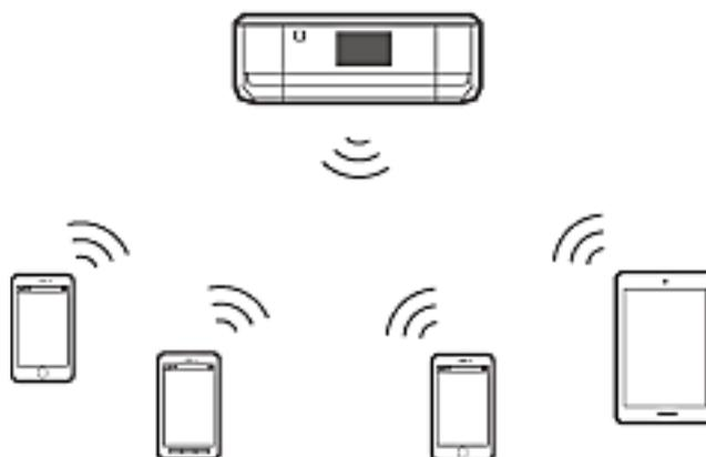
La stampante può venire simultaneamente connessa tramite Wi-Fi e con il modo AP semplice. Tuttavia, se si inizia una connessione di rete nel modo AP semplice quando la stampante è connessa tramite Wi-Fi, la connessione Wi-Fi viene temporaneamente disconnessa.
