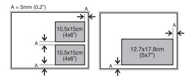
☐ Se si effettua la scansione con **Modo Automatico** o con l'anteprima miniature di EPSON Scan, collocare l'originale ad una distanza di 4,5 mm dal contrassegno d'angolo del vetro dello scanner.
