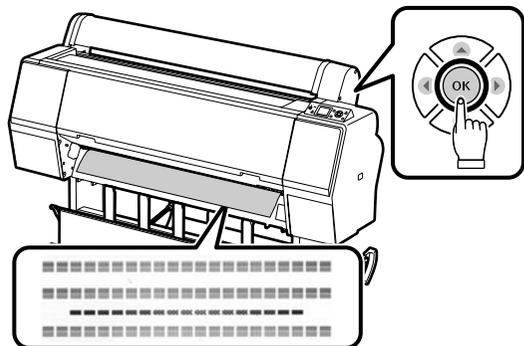
Stlačením OK vytlačíte vzor a začnete proces automatického nastavenia, ktorý bude trvať asi 6 minút.
