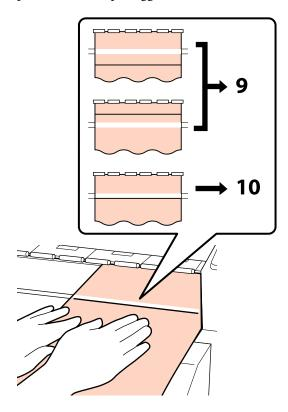
Mentre si controlla lo stato delle due linee sul lato anteriore della stampante, utilizzare la chiave esagonale per regolare la vite in modo che la linea disegnata sia allineata alla posizione della linea tratteggiata.
