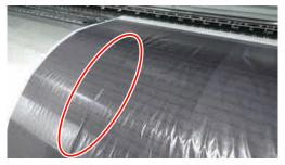
Se supporti sottili o allungati per assorbimento d'acqua vengono stampati ad alta densità e vengono avvolti, possono comparire pieghe dopo il riscaldamento. Nel menu di impostazione, impostare **Tensione Avvolgimento** su **Manuale**, e impostare il valore su **Lv1** o **Lv2**. In alternativa, consigliamo di utilizzare supporti più spessi.
