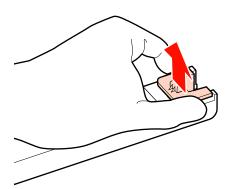
Sul dispositivo di scorrimento montare l'unità chip fornita con la nuova confezione d'inchiostro.
