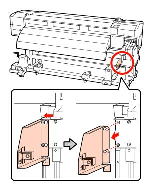
Fissare la barra di guida del supporto
