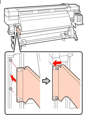
Utilizzare la chiave esagonale (grande) per serrare e fissare saldamente le due viti posizionate in modo provvisorio.
