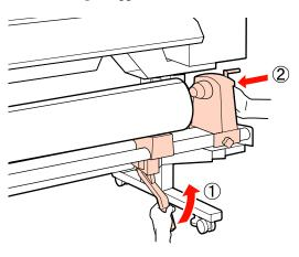
Per garantire un sufficiente inserimento del portarotolo nell'anima del rotolo, spingere per due volte la sezione centrale sul lato del portarotolo verso l'estremità del rotolo.
