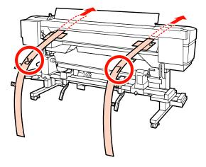
Come mostrato nell'illustrazione, allineare il Foro 1 del film b con le viti sui bordi sinistro e destro della guida di caricamento quindi farlo aderire.
