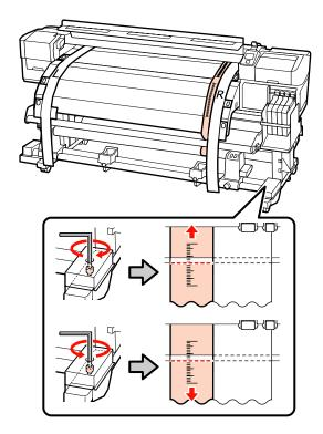
Utilizzare la chiave esagonale grande per fissare saldamente le 4 viti.
