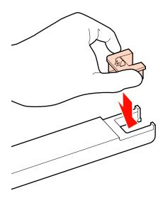
Tenere la leva del dispositivo di scorrimento ed inserirla, quindi abbassare la leva di arresto.
