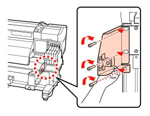
(2) Utilizzare la chiave esagonale (piccola) per serrare e fissare saldamente le due viti.
