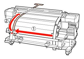
Controllando dalla parte frontale e posteriore della stampante, allineare rigorosamente il film a con il film b.
