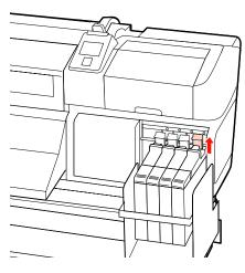
Inserire un dito nella rientranza nella parte superiore del dispositivo di scorrimento ed estrarlo verso l'esterno.
