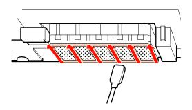
Inumidire il bastoncino di pulizia (largo) con il kit solvente per inchiostro, quindi rimuovere la polvere e lo sporco sulla parte anteriore, posteriore e laterale della spazzola.
