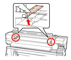
Allentare sufficientemente le viti di fissaggio del portarotolo e regolare i portarotolo in modo che la distanza tra i due portarotolo sia superiore alla larghezza dei supporti cartacei.
