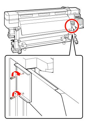
(4) Utilizzare la chiave esagonale (grande) per serrare e fissare saldamente una vite.
