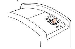
Inserire il supporto cartaceo oltre i rulli di pressione e abbassare la leva di caricamento supporto per mantenerlo in posizione.
