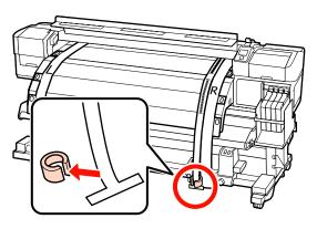
Tirare il film a dalla parte posteriore della stampante. Quindi, allentare la vite di fissaggio del portarotolo destro e allontanare il portarotolo.
