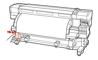
8 Serrare la vite di bloccaggio del supporto per anima rotolo sinistro per fissarlo in posizione.
