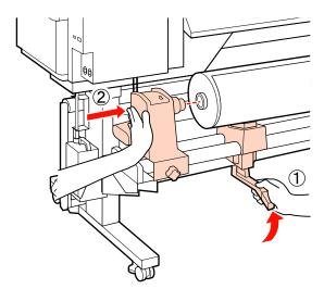
Serrare la vite di fissaggio del portarotolo fino a quando la vite non è più in grado di ruotare per fissarlo in posizione.
