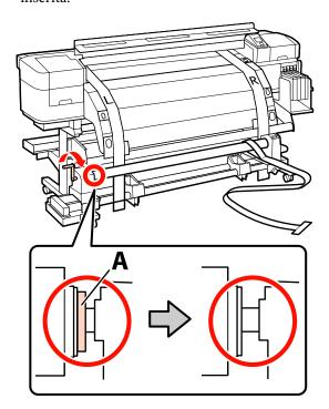
Portare il film a al lato sinistro del film b. Far passare il bordo guida del film a tra la barra di guida del supporto e il post riscaldatore quindi inserirlo nella stampante.
