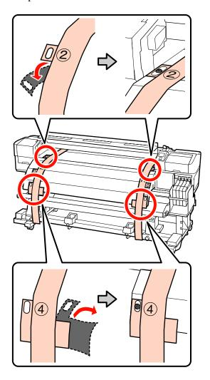
Sulla parte posteriore della stampante, allentare le viti di fissaggio del portarotolo sui lati destro e sinistro. Quindi, serrare la vite di fissaggio del portarotolo per allineare il portarotolo sinistro alla posizione della linea tratteggiata.
