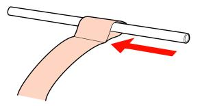
Inserire l'anima rotolo nel portarotolo sinistro. Inserire il portarotolo destro all'anima del rotolo, quindi serrare la vite di bloccaggio del portarotolo.
