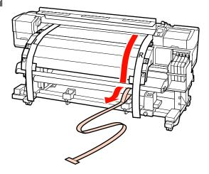
Portare il film a al lato sinistro del film b. Fa passare il bordo guida del film a dalla parte anteriore della barra di guida del supporto quindi inserirlo nella stampante.
