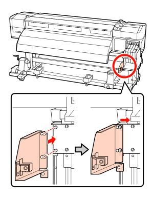
(2) Utilizzare la chiave esagonale (grande) per serrare e fissare saldamente le due viti posizionate in modo provvisorio.
