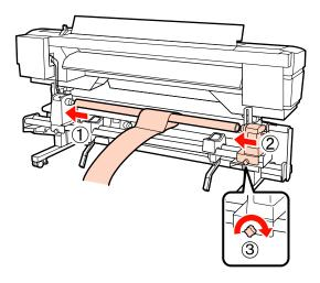
Ruotare la maniglia fino a che la parte A nella figura sotto riportata risulta interamente inserita.
