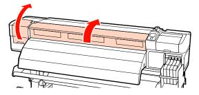
Rimuovere la piastra di sostegno supporto target.
