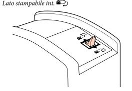
Inserire il supporto cartaceo oltre i rulli di 14 pressione e abbassare la leva di caricamento supporto per mantenerlo in posizione.
