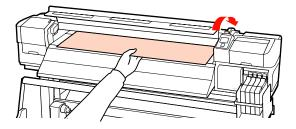
Tirare il supporto direttamente in avanti fino al bordo iniziale della guida di espulsione.
