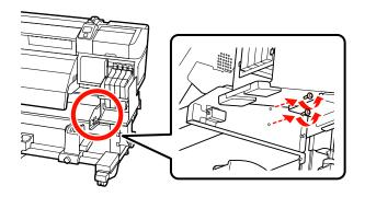
(2) Sostenendo il dispositivo, utilizzare una chiave esagonale (grande) per rimuovere le tre viti.
