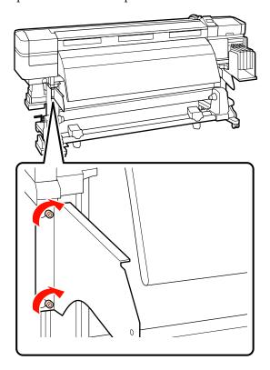
4 Utilizzare la chiave esagonale (piccola) per serrare le 4 viti e fissare la barra di guida del supporto.
