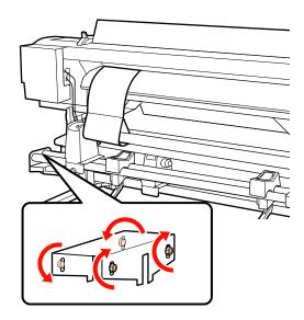
Estrarre la carta di regolazione dalla stampante, allentare la vite di fissaggio del portarotolo destro, e allontanare il portarotolo.
