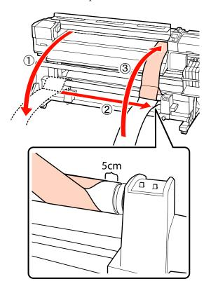
Mantenere tesa la carta di regolazione e controllare le posizioni della linea bianca sulla platina e della linea tracciata nel passaggio 6.
