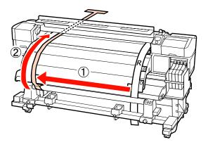
Dalla parte anteriore e posteriore della stampante, sollevare il film a e spostarlo in modo che si allinei rigorosamente con il film b. Dalla parte posteriore della stampante, collegare un contrappeso al film a.
