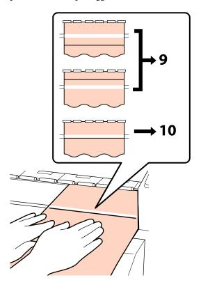
Mentre si controlla lo stato delle due linee sul lato anteriore della stampante, utilizzare la chiave esagonale (grande) per regolare la vite in modo che la linea disegnata sia allineata alla posizione della linea tratteggiata.
