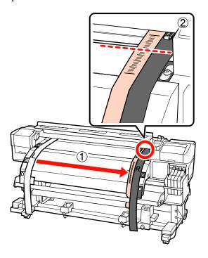
Ontrollando la gradazione del film a sul lato anteriore della stampante, utilizzare la chiave esagonale grande per la regolazione.
