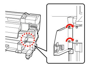
(3) Utilizzare la chiave esagonale (grande) per serrare e fissare saldamente le 2 viti.
