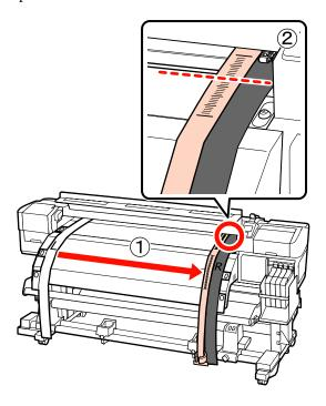
Mentre si controlla la gradazione del film a nella parte anteriore della stampante, eseguire la regolazione sulla parte posteriore della stampante.
