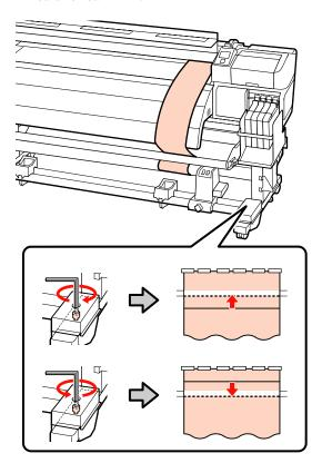
Utilizzare la chiave esagonale (grande) per serrare e fissare saldamente le 4 viti.
