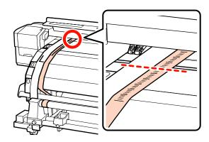
Dalla parte anteriore e posteriore della stampante, sollevare il film a e spostarlo in modo che si allinei rigorosamente con il lato destro del film b. Quando il film a cessa di oscillare, controllare la gradazione nel punto in cui passa il lato anteriore della linea bianca della platina.
