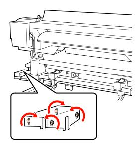
Allentare le viti di fissaggio del portarotolo e regolare i portarotolo in modo che la distanza tra i due portarotolo sia superiore alla larghezza dell'anima del rotolo.
