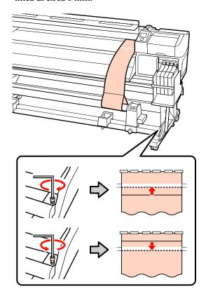
Utilizzare la chiave esagonale per serrare e fissare saldamente le 4 viti.
