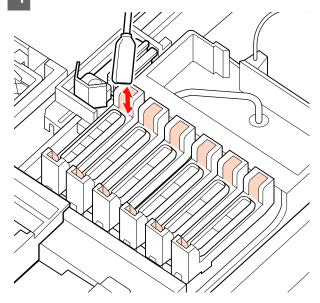
Tenere un nuovo bastoncino di pulizia con orientamento perpendicolare, e rimuovere ogni residuo di kit solvente per inchiostro rimasto all'interno dei tappi Anti-essiccazione.
