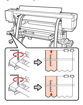
Utilizzare la chiave esagonale grande per fissare saldamente le 4 viti.
