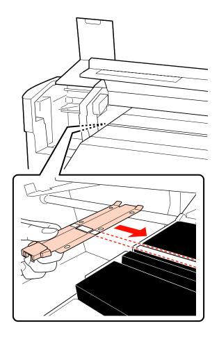
(2) Premendo la punta della piastra metallica contro il rullo, fissare le sezioni a uncino all'angolo anteriore del rullo.
