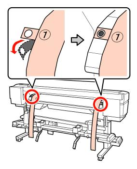
Come mostrato nell'illustrazione, allineare i Fori 2 e 4 del film b nella parte anteriore della stampante con le viti sul lato sinistro e destro del post riscaldatore quindi farli aderire.
