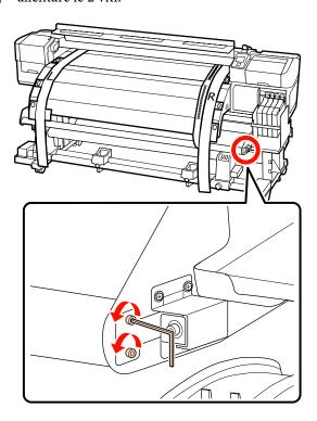
Mentre si controlla la gradazione del film a sul lato anteriore della stampante, eseguire le regolazioni utilizzando la chiave esagonale grande afferrando con una mano la barra di guida del supporto.
