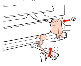
Per garantire un sufficiente inserimento del portarotolo nell'anima del rotolo, spingere per due volte la sezione centrale sul lato del portarotolo verso l'estremità del rotolo.
