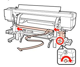
Ruotare la maniglia fino a che la parte A nella figura sotto riportata risulta interamente inserita.
