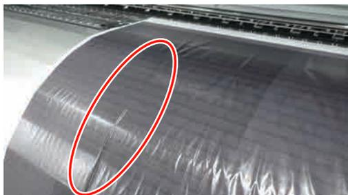
Se o papel fino ou papel alterado pela ação da absorção da água impresso a uma densidade elevada estiver a ser enrolado, podem surgir faixas no papel após o aquecimento. No menu de configuração, defina a **Tensão de enrolamento** como **Manual**, e defina o valor como **Lv1** ou **Lv2**. Alternativamente, recomendamos utilizar um papel mais espesso.
