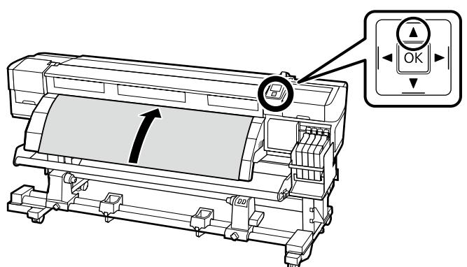
Jeśli media są ładowane stroną zadrukowywaną skierowaną do wewnętrz, naciśnij przycisk ▼, aby przewinąć media. zalecamy naciśnięcie przycisku ► na panelu sterowania i ustawienie opcji **Media Suction** (Wciąganie mediów) na 2.
