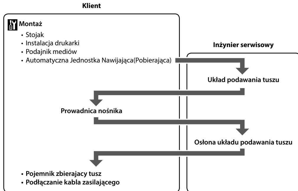
Požádejte servisního technika o připojení „systém přívodu inkoustu“ a „kryt systému přívodu inkoustu“. Pokusíte-li se tyto úkony provést vlastními silami, mohlo by dojít k závadě nebo k poškození výrobku a k propadnutí záruky na výrobek.
