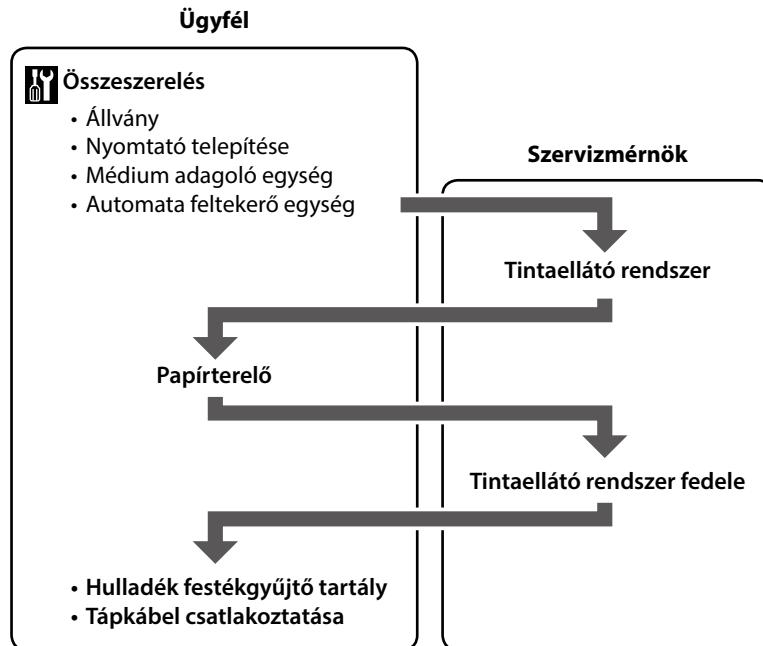
Чтобы установить на принтер "Система подачи чернил" и "Крышка системы подачи чернил", обратитесь к инженеру, выполняющему техническое обслуживание. Попытка выполнить данные работы самостоятельно может привести к неполадкам в работе принтера либо к его повреждению, а также аннулирует связанные с ним гарантийные обязательства.
