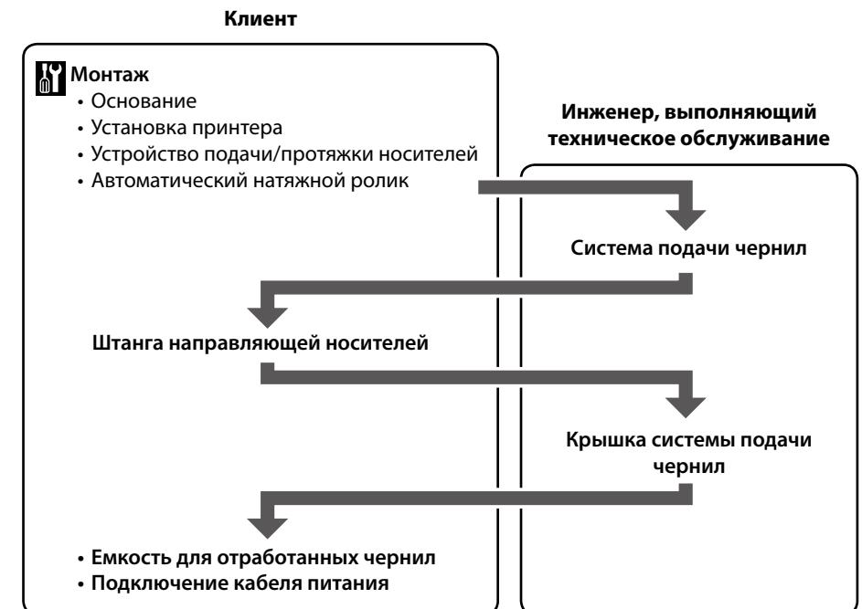
Встановлення компонентів "Система постачання чорнил" і "Кришка системи постачання чорнил" має виконувати інженер-налагодник. Самостійне виконання цих процедур може привести до збоїв у роботі приладу чи виходу його з ладу, а також до скасування гарантії на прилад.
