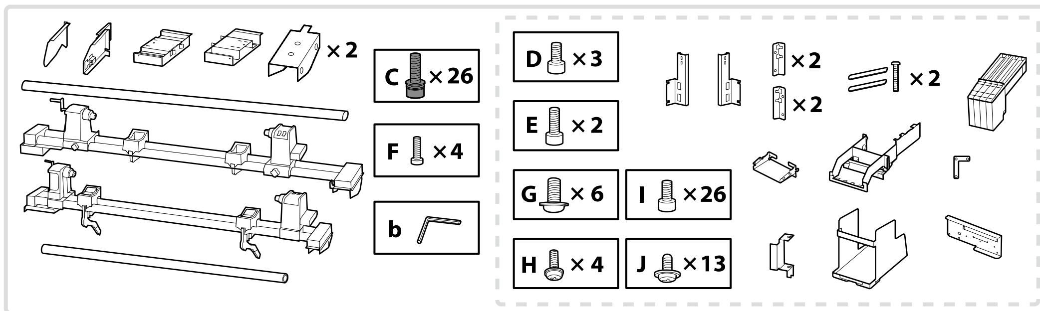
Linia przerywana oznacza części elementów „Układ podawania tuszu” i „Osłona układu podawania tuszu”.
