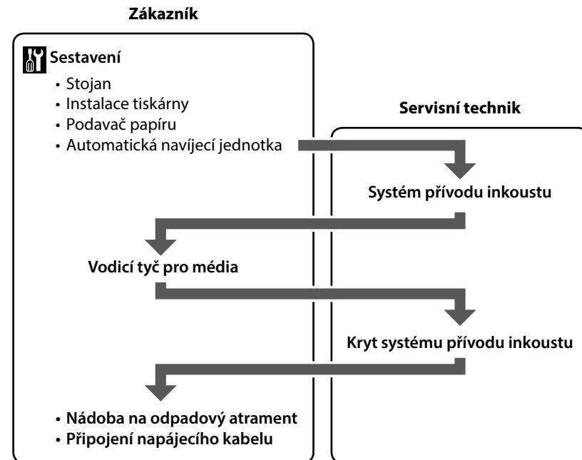
Lépjön kapcsolatba egy szervizmérnökkal, aki csatlakoztatja a "Tintaellátó rendszer"-t és a "Tintaellátó rendszer fedele"-t. A saját kezűleg elvégzett beállítások a termék meghibásodásához vagy károsodásához vezethetnek, és ez érvényteleníti a termékgaranciát.
