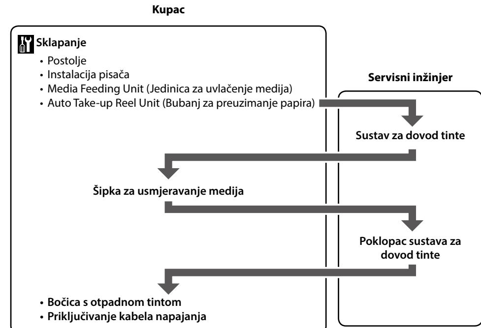
Повикајте сервисер да ги приклучи „Ink Supply System“ и „Ink Supply System Cover“. Ако се обидете самите да ги изведете овие задачи, може да дојде до дефект или оштетување на производот и поништување на гаранцијата.
