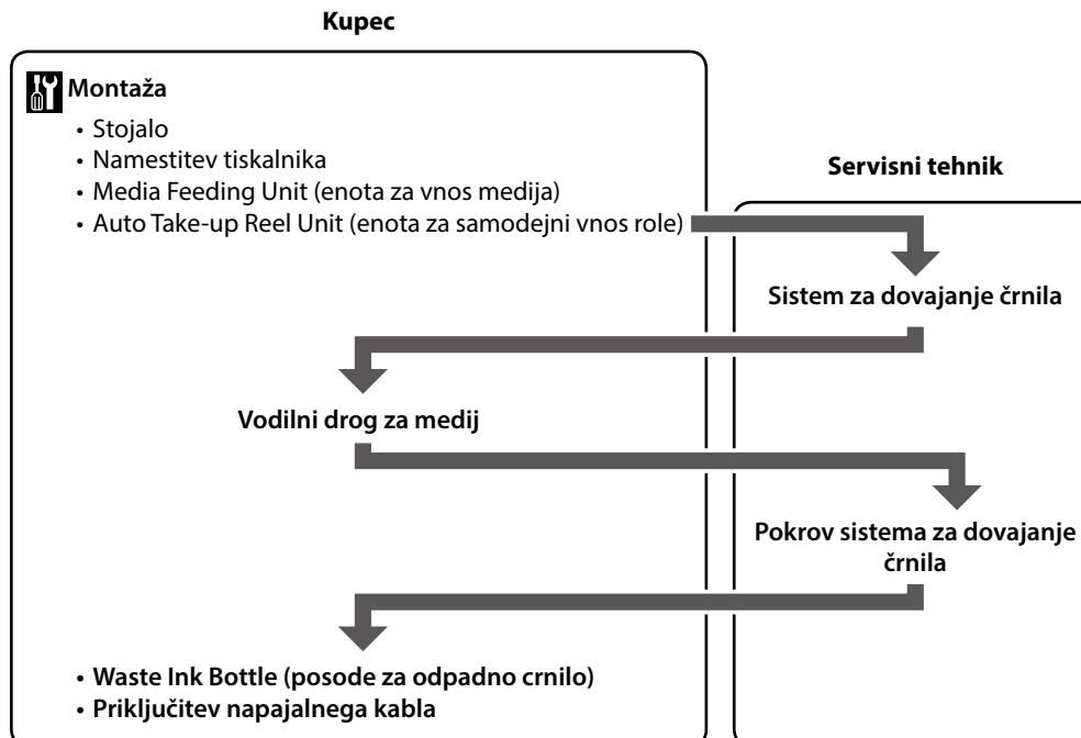
Kontaktirajte inženirja zaduženog za postavljanje „Sustav za dovod tinte“ i „Poklopac sustava za dovod tinte“. U slučaju samostalno pokušate provesti ove postupke, može doći do kvara ili oštećenja proizvoda, te se poništava jamstvo.
