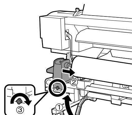
Ortam silindirinin dış çapı 140mm'den az ise, elinizle kaldırın ve silindir tutucuya yerleştirin.
