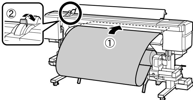
Sağdaki şekilde gösterildiği gibi, ortamın sol ucu dikdörtgen alanın merkezinde değilse, adım [4]'e dönün.
