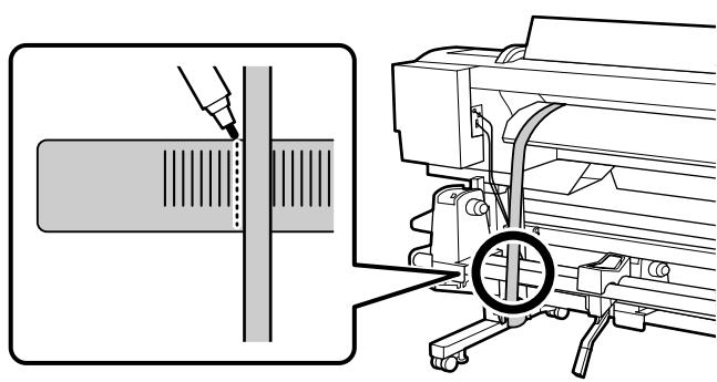
Filmi aşağı doğru çekin ve Medya Besleme Ünitesi'nin ön çubuğundaki etiketin üzerine koyun. Yağ bazlı kalem gibi bir işaretleme kalemi kullanarak etiket üzerindeki filmin sol uç konumunu işaretleyin.
