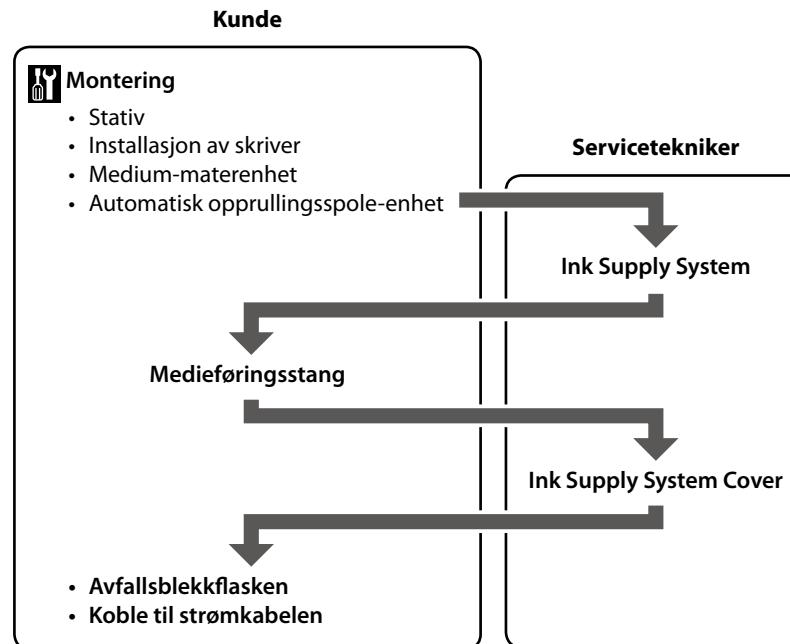
Kontakta en servicetekniker för att fästa enhetens "Bläckmatningssystem" och "Bläckmatningssystemets lucka". Försök att utföra dessa uppgifter själv kan resultera i funktionsfel eller skada på produkten och upphäver garantin.
