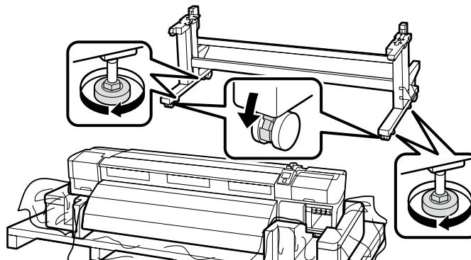
Før anvendelse af printeren skal du sikre dig, at stativet står rigtigt fast. Sørg for, at hjulene ikke svæver i luften. Når du flytter printeren, skal du dreje stativfastgørelsesskruerne i modsat retning for at hæve dem og derefter låse hjulene op.
