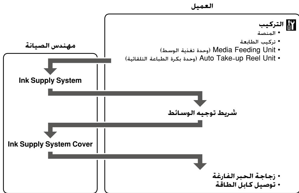
برای نصب "Ink Supply System Cover" (سیستم تأمین جوهر) و "Ink Supply System" (پوشش سیستم تأمین جوهر). با مهندس خدمات تماس بگیرید. تلاش برای انجام این وظایف توسط شخص شما ممکن است باعث خرابی عملکرد دستگاه یا آسیب رسیدن به محصول شود و باعث ابطال ضماننامه می شود.
