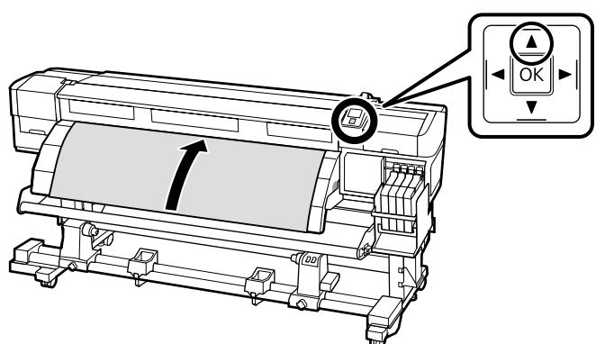
Hvis mediet er ilagt med den printbare side indad, skal du trykke på knappen ▼ for at spole mediet tilbage. Vi anbefaler, at du trykker på knappen ► på kontrolpanelet og indstiller **Media Suction** (Mediesugning) til 2.
