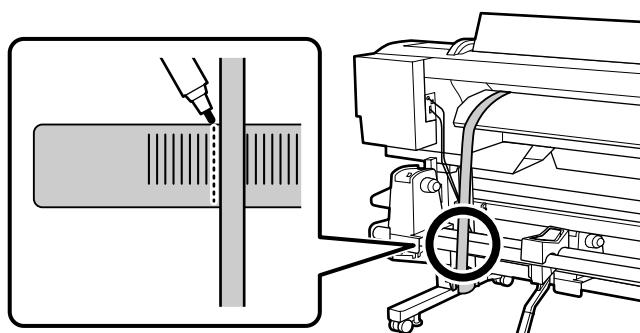
Træk filmen lige ned, og placer den over mærkaten på den forreste stang på Media Feeding Unit (Papirfremføringsenhed). Brug en markør såsom en oliebaseret pen til at markere venstre endeposition af filmen på mærkaten.
