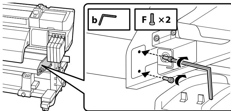
Sørg for, at de to skruer, der er vist på figuren, er tilspændt midlertidigt, indtil paralleljusteringen er fuldendt.
