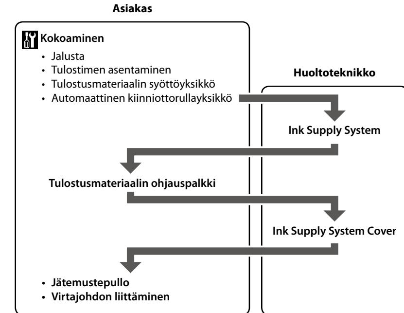
Kontakta en servicetekniker for å feste "Ink Supply System" og "Ink Supply System Cover". Hvis du prøver å utføre disse oppgavene selv, kan det føre til at produktet ikke fungerer som det skal, føre til skade på produktet og gjøre garantien ugyldig.
