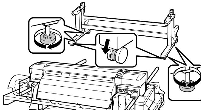
Przed rozpoczęciem używania drukarki należy się upewnić, że stojak jest zamocowany na miejscu. Należy się upewnić, że kółka nie znajdują się w powietrzu. Podczas przesuwania drukarki należy obracać śrubami mocującymi stojak w przeciwnym kierunku, aby je unieść, a następnie odblokować kółka.
