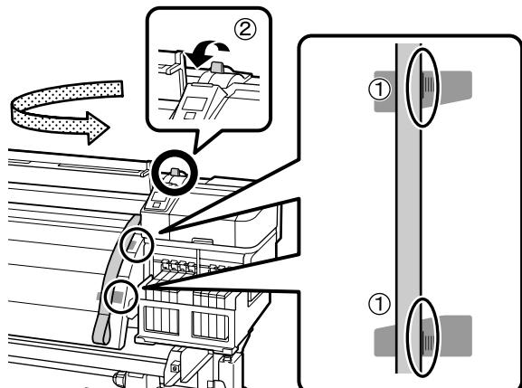
Wyrównaj prawą krawędź z najdłuższymi oznaczeniami na skalach (w środkowej części etykiet) po przedniej stronie drukarki.
