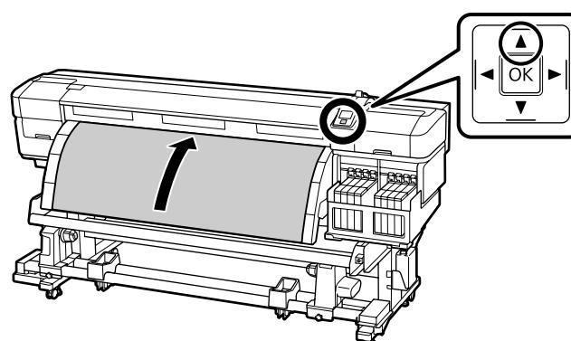
Jeśli media są ładowane stroną zadrukowywaną skierowaną do wewnętrz, naciśnij przycisk ▼, aby przewinąć media. zalecamy naciśnięcie przycisku ► na panelu sterowania i ustawienie opcji **Media Suction** (Wciąganie mediów) na 2.
