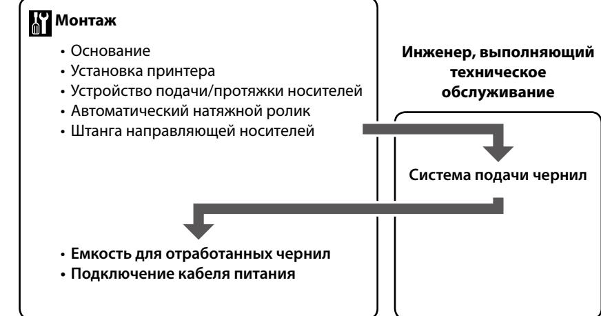
Встановлення компонента “Система постачання чорнил” має виконувати інженер-налагодник. Самостійне виконання цих процедур може привести до збоїв у роботі приладу чи виходу його з ладу, а також до скусування гарантії на прилад.
