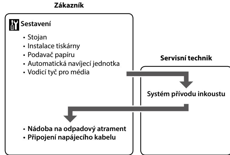
Lépjön kapcsolatba a szervizmérnökkel, aki csatlakoztatja az "Tintaellátó rendszer"-et. A saját kezűleg elvégzett beállítások a termék meghibásodásához vagy károsodásához vezethetnek, és ez érvényteleníti a termékgaranciát.
