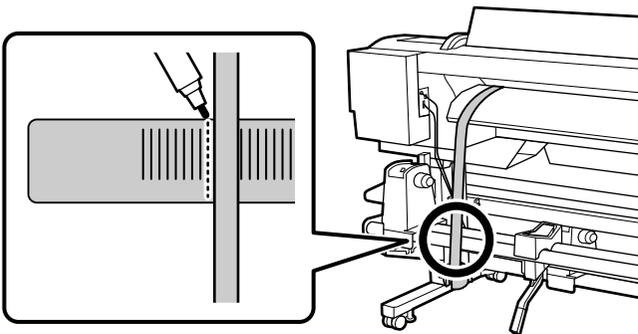
Potiahnite fóliu priamo nadol a položte ju cez štítok na prednej lište Jednotka na podávanie papiera. Pomocou popisovača (napr. olejového pera) označte pozíciu ľavého okraja fólie na štítku.
