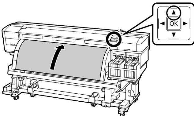
Ak je papier vložený tlačiteľnou stranou dnu, stlačte tlačidlo ▼ pre prevnutie papiera. Odporúčame Vám stlačiť tlačidlo ► na ovládacom paneli a nastaviť **Media Suction** na 2.
