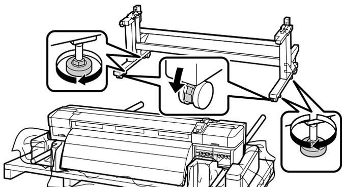
Pred používaním tlačiarne sa uistite, že podstavec je pripevnený na miesto. Uistite sa, že kolieska nevisia vo vzduchu. Keď prenášate tlačiareň, otočte pripevňovacími skrutkami tlačiarne do opačného smeru, aby ste ich nadvihli, a potom odomknite kolieska.
