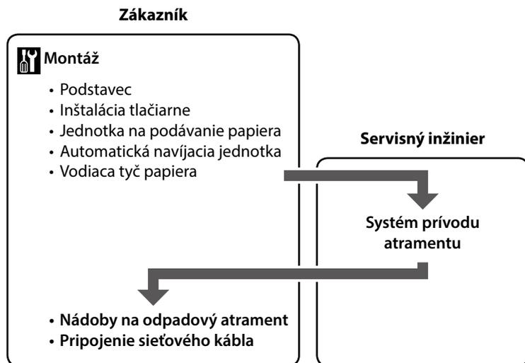
Luați legătura cu un inginer de service pentru a monta „sistemul de alimentare cu cerneală“. Încercarea de a efectua aceste lucrări singur, poate avea ca rezultat funcționarea incorectă sau defectarea produsului și va invalida garanția.
