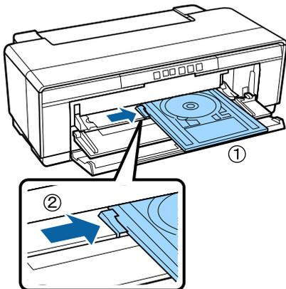
**7** Deslice la bandeja de CD/DVD y alinee los triángulos de la bandeja de CD/DVD con los de la bandeja frontal de alimentación manual.
