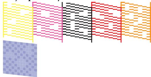
Si falta algún segmento en el patrón de test de inyectores, realice una limpieza de cabezales.
