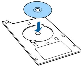
**6** Coloque el borde de entrada de la bandeja de CD/DVD en la bandeja frontal de alimentación manual y ajuste la guía del borde a la anchura de la bandeja de CD/DVD.
