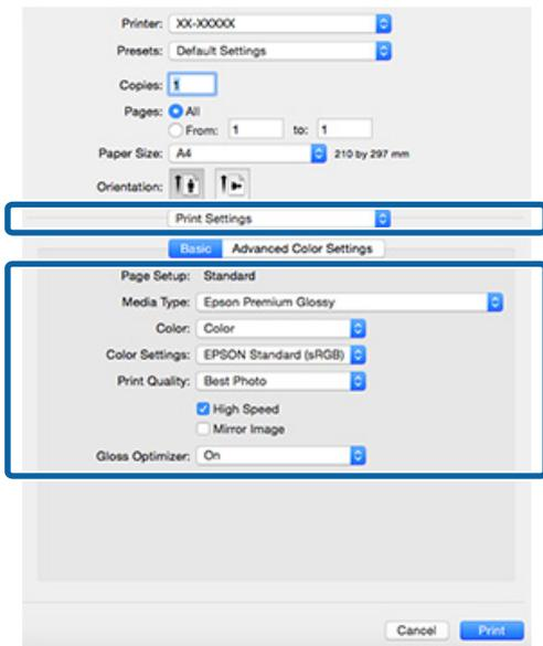
Ajuste los valores **Media Type (Tipo papel)**, **Color**, **Print Quality (Resolución)** y otros valores según el papel cargado en la impresora. Para una impresión normal, basta con configurar las opciones de la pantalla **Print Settings (Ajustes Impresión)**.
