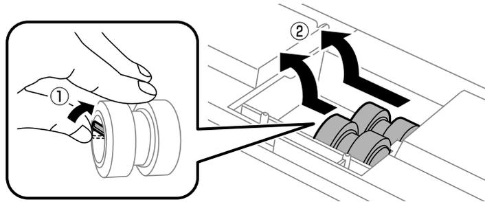
8. Setzen Sie die beiden neuen Wartungswalzen ein, bis diese hörbar einrasten.
