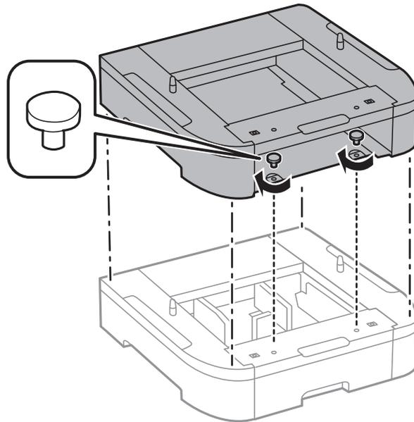
8. Setzen Sie den Drucker vorsichtig auf die optionale Papierkassette ab und achten Sie dabei darauf, dass die Kanten bündig abschließen. Befestigen Sie den Drucker mit den Schrauben an der optionalen Papierkassette.
