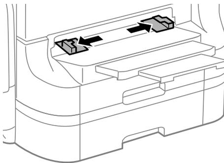
3. Legen Sie das Papier mit der zu bedruckenden Seite nach unten ein, bis der Drucker das Papier leicht einzieht.
