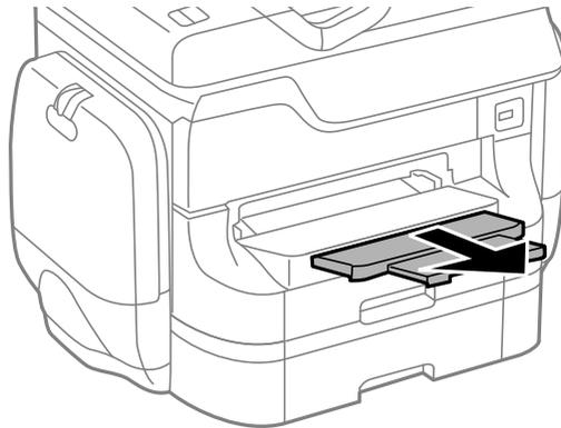
2. Richten Sie die Papierführungsschienen am verwendeten Papierformat aus.
