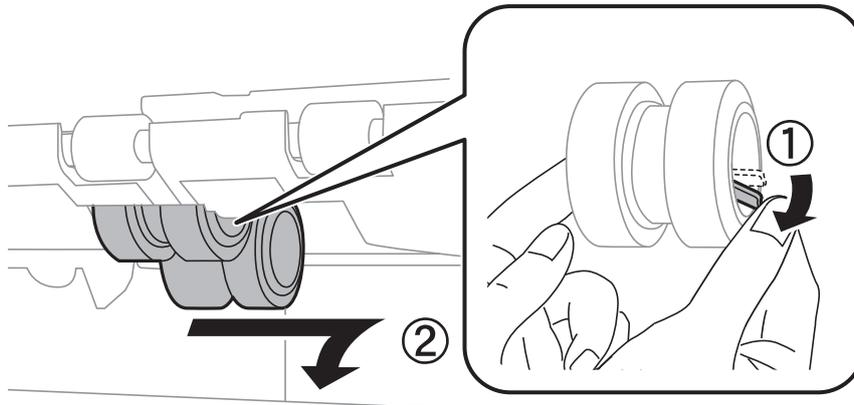
7. Setzen Sie die beiden neuen Wartungswalzen ein, bis diese hörbar einrasten.
