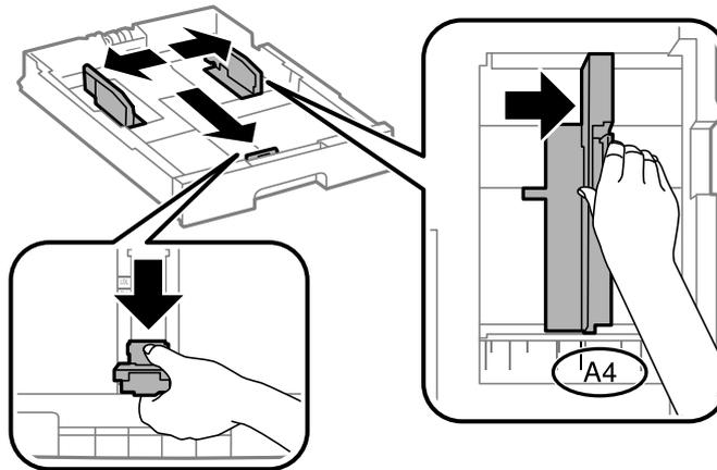
3. Legen Sie Papier mit der zu bedruckenden Seite nach unten ein und schieben Sie dann die vordere Papierführungsschiene an die Papierkante heran.
