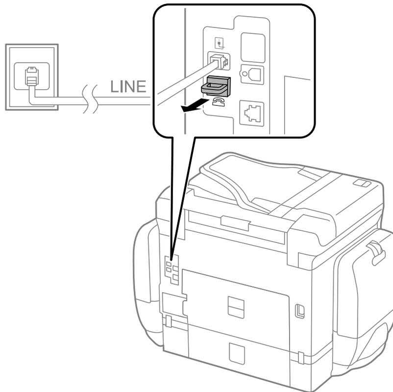
2. Verbinden Sie den Telefonapparat über ein Telefonkabel mit dem EXT.-Anschluss.
