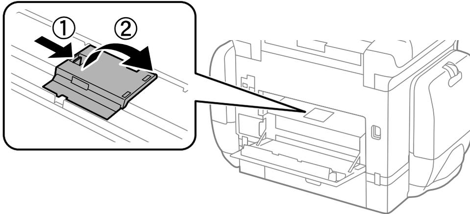
7. Schieben Sie die beiden verbrauchten Wartungswalzen heraus und entfernen Sie sie.
