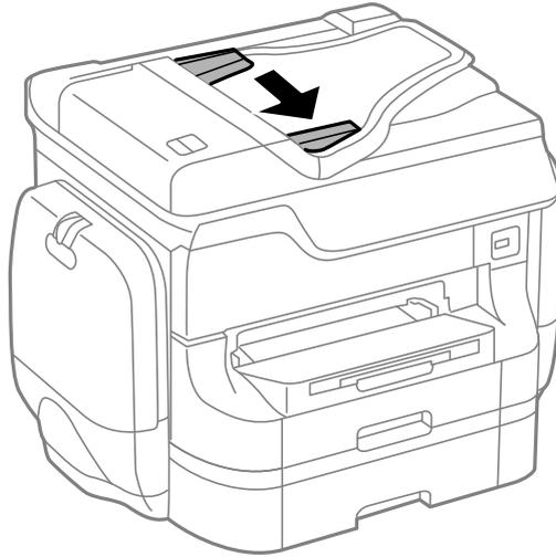
3. Legen Sie die Vorlagen mittig und mit der bedruckten Seite nach oben auf den ADF.
