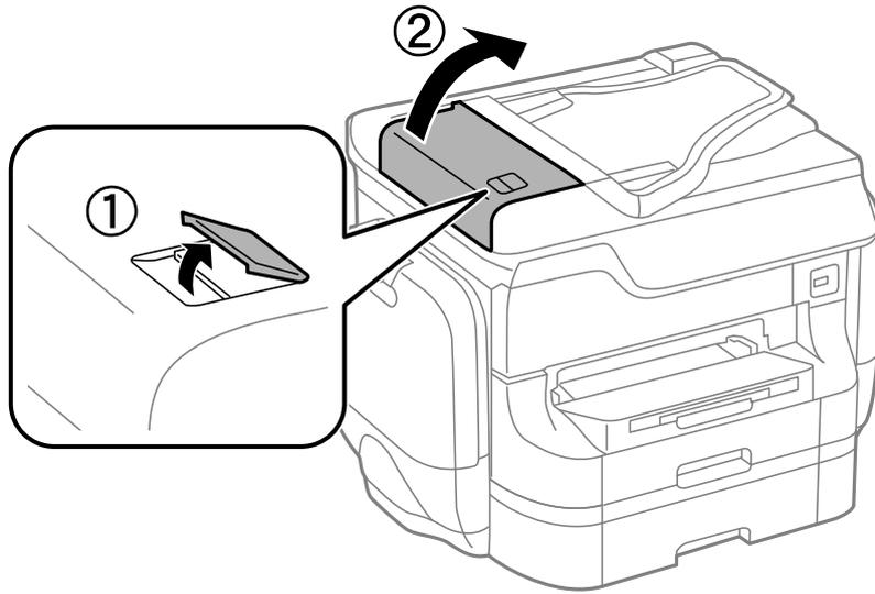
2. Reinigen Sie die Rolle und die Innenseite des ADF mit einem weichen, trockenen und sauberen Tuch.
