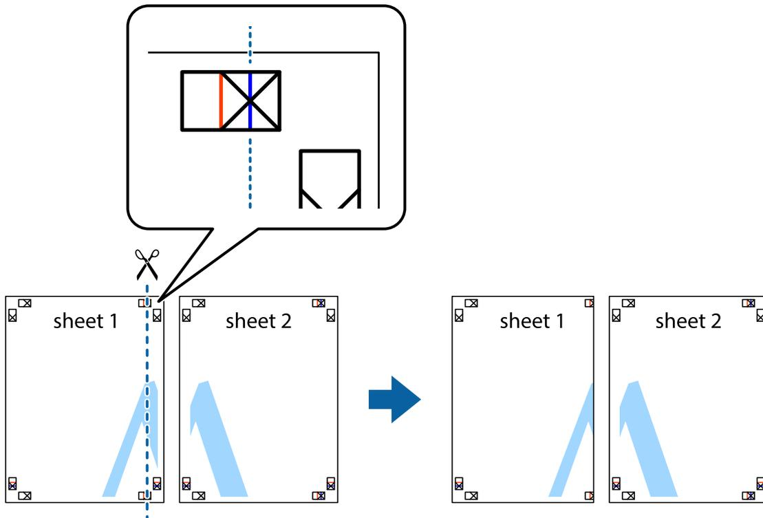
2. Platzieren Sie die Kante von Sheet 1 auf Sheet 2 und richten Sie die Kreuzmarkierungen aneinander aus. Fügen Sie die beiden Blätter mit Klebeband auf der Rückseite vorübergehend zusammen.
