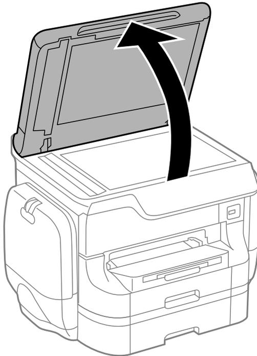
2. Reinigen Sie die Oberfläche des Vorlagenglases mit einem weichen, trockenen, sauberen Tuch.
