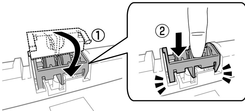
13. Setzen Sie die hintere Abdeckung 2 ein, schließen Sie die hintere Abdeckung 1 und legen Sie dann die Papierkassette wieder ein.
