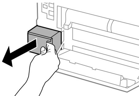
4. Τοποθετήστε το χρησιμοποιημένο κουτί συντήρησης στη διαφανή σακούλα που παρέχεται με το νέο κουτί συντήρησης και σφραγίστε τη.
