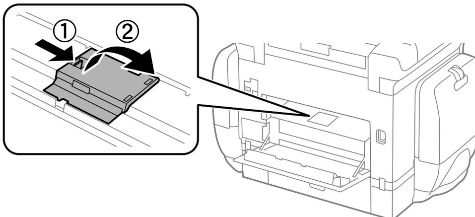
7. Σύρετε προς τα έξω τους δύο χρησιμοποιημένους κύλινδροι συντήρησης και αφαιρέστε τους.
