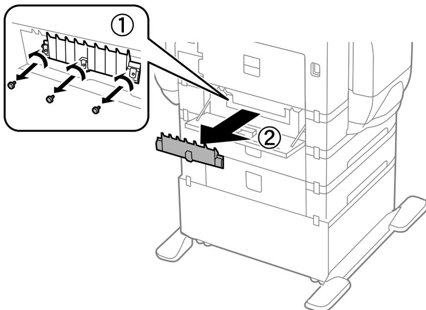
6. Σύρετε προς τα έξω τους δύο χρησιμοποιημένους κύλινδροι συντήρησης και αφαιρέστε τους.
