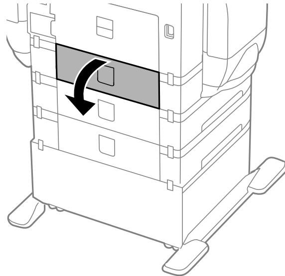
5. Выкрутите винты с помощью отвертки и снимите крышку с задней панели внутренней части принтера.
