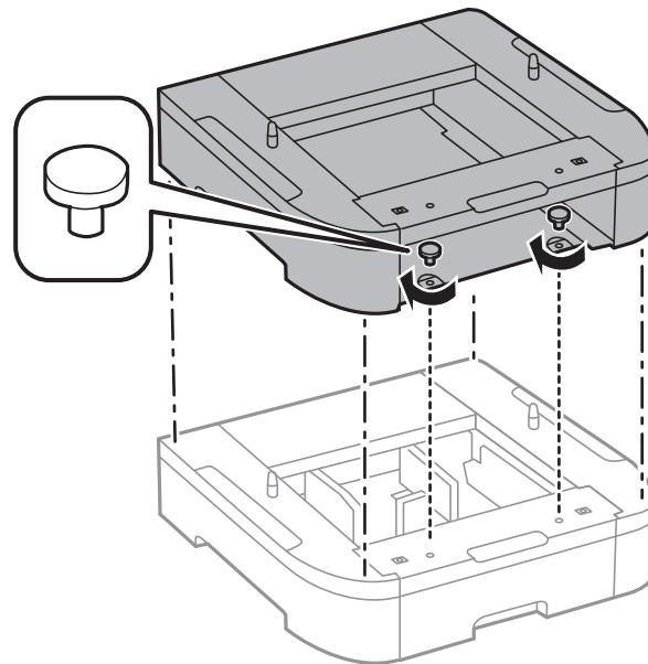
8. Осторожно опустите принтер на дополнительную кассету для бумаги так, чтобы совпали углы, и закрепите по углам винтами.
