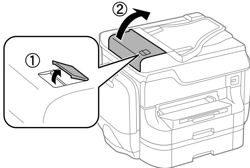
2. Для очистки ролика и внутренней поверхности автоматического податчика необходимо использовать мягкую, сухую, чистую ткань.
