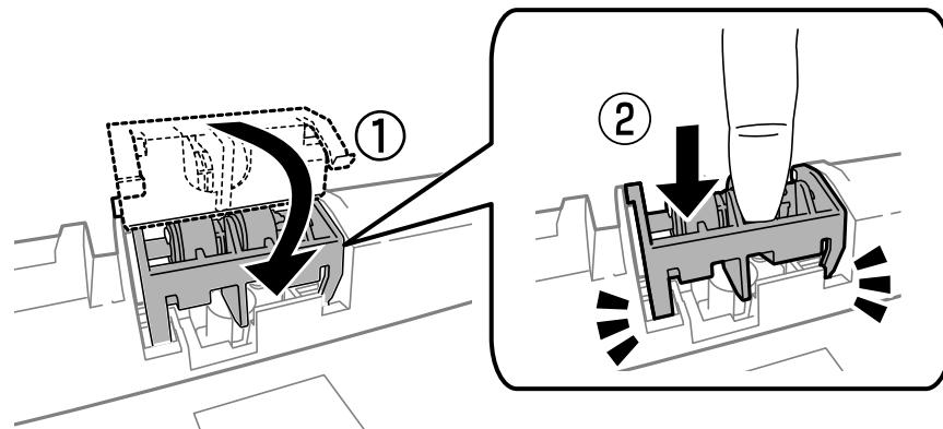
13. Вставьте задняя крышка 2, закройте заднюю крышку 1, а затем вставьте кассета для бумаги.
