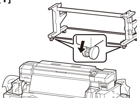
Før anvendelse af printeren skal du sikre dig, at stativet står riktig fast. Lås hjulene op, når du flytter printeren.
